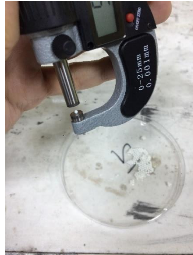
Şekil 3. 7. Mikroküre şişme deneyi ve mikroküre hacimlerinin belirlenmesi
