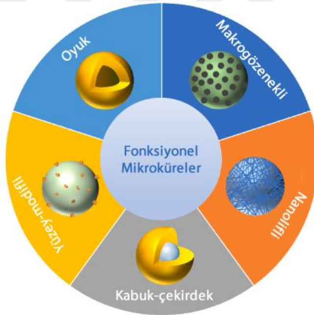
Şekil 2. 21. Farklı tasarımlarda fonksiyonel mikroküre yapıları (Q. Li vd., 2022)
