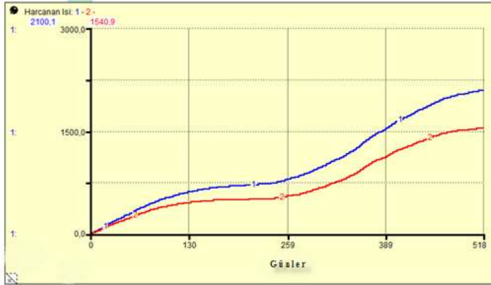
Şekil 3.22. Senaryo 1; ayarlanan sıcaklığın düşürülmesiyle oluşan simülasyon grafiği (Kırmızı renkli eğri 1. Senaryonun gösterimidir).
