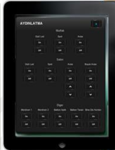
Şekil 19. Aydınlatma Kontrol Paneli (Bal, 2017)
