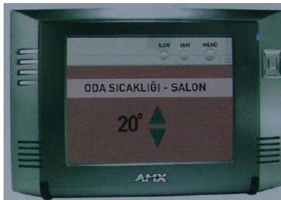
Şekil 23. Oda Sıcaklık Derecesi Seçilmiş Touch Panel (Aslan 2014)
