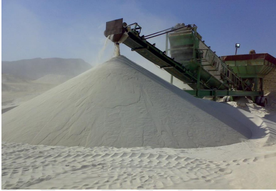
Şekil 2. 14: Mobil konkasörde kırılarak elde edilen kum.
