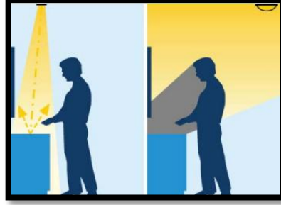
Şekil 4.10: Banyoda oluşturulan aydınlatmanın sırasıyla doğru ve yanlış uygulama şeması [IES, CP-2-10].
