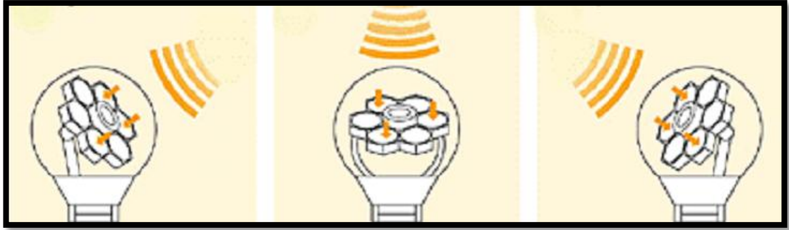
Şekil 2.17: Himewari sisteminin gün ışına göre hareketi [Url-12].
