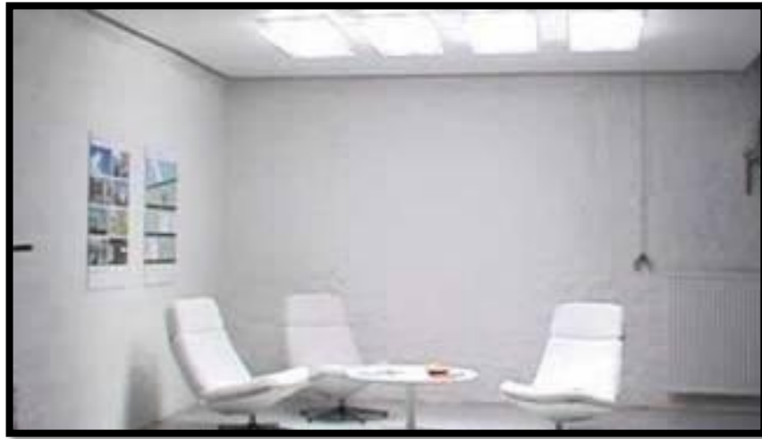
Şekil 2.18: Fiber optik ile hacimlere günışığının taşınması [Url-13].
