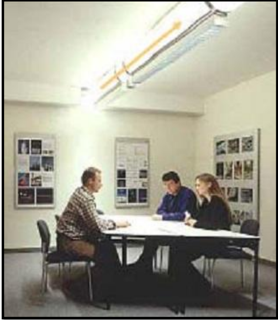
Şekil 2.15: Işık kılavuzu ile gün ışığının hacim içinde kullanılması [Okutan, 2008].
