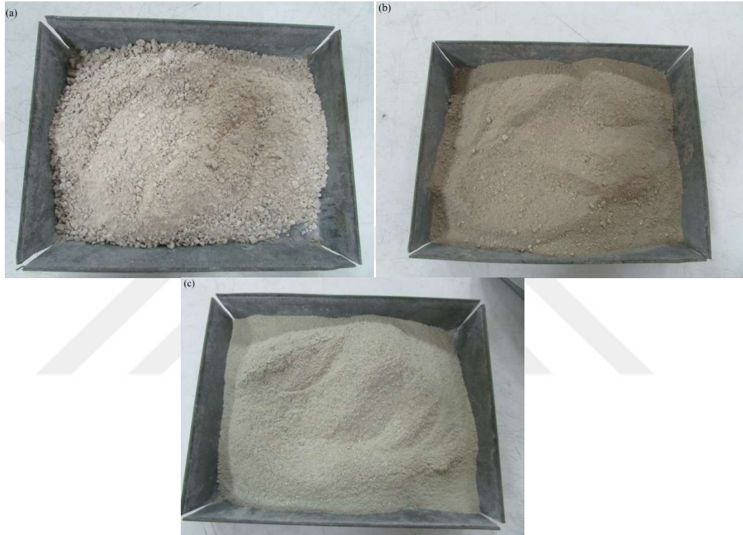
Şekil 3.1. Kullanılan agrega çeşitleri: a) Kırma kum, b) Pomza, c) Zeolit
