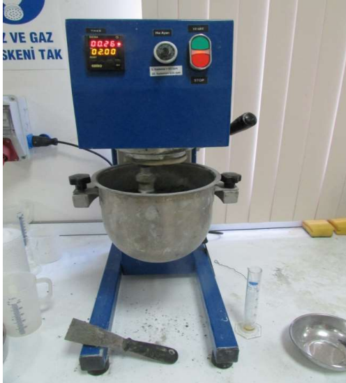
Şekil 3.8. Harç karışımlarının üretildiği mikser
