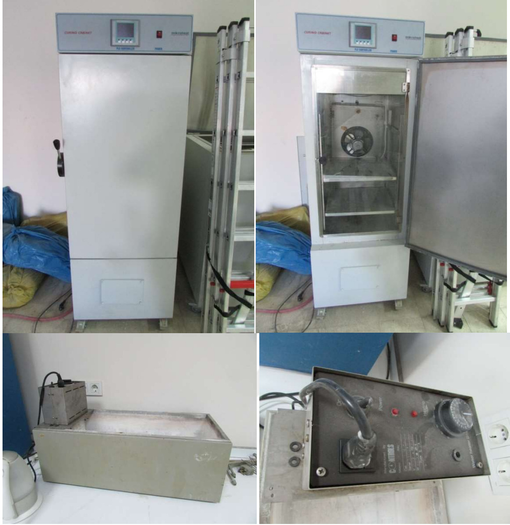
Şekil 3.12. Buhar kürü (üstte), Sıcak su kürü (altta)
