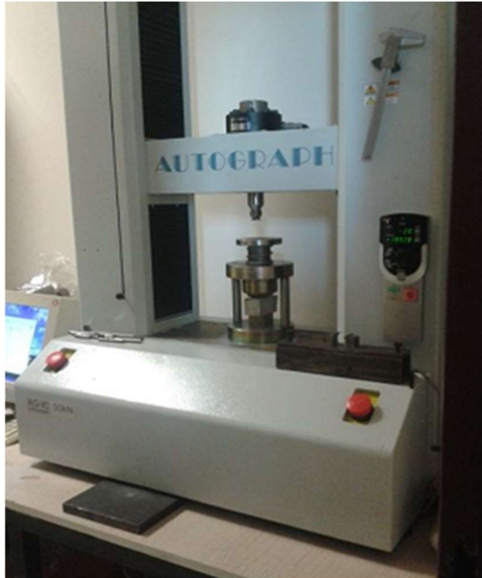
Şekil 3.20. Gerilme-şekil değiştirme davranışı deney düzeneği
