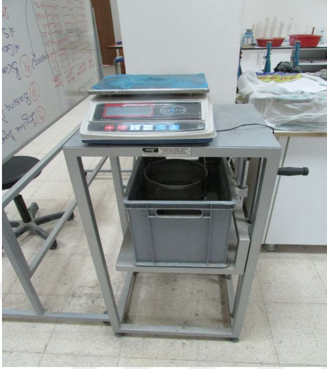
Şekil 3.13. Sertleşmiş harç numunelerin KBA ve SDKY değerlerini tayin etmede kullanılan deney düzeneği
