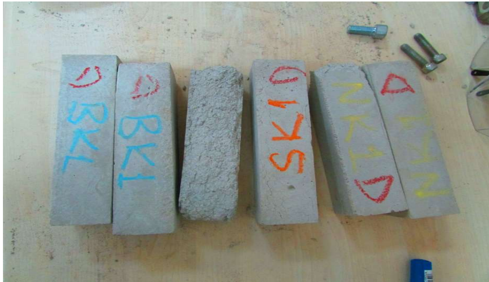
Şekil 4.59. Donma-çözülme çevrimi deneyi sonucu bazı numune görünüşleri
