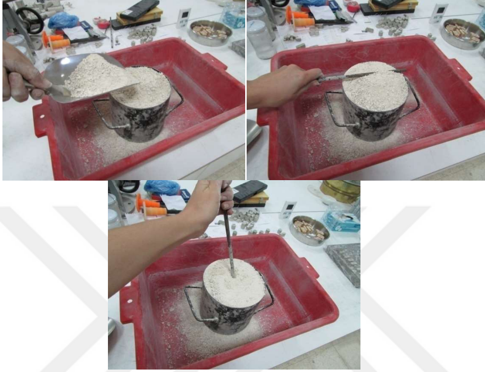
Şekil 3.7. Agregaların gevşek ve sıkışık birim hacim ağırlıklarının belirlenmesi
