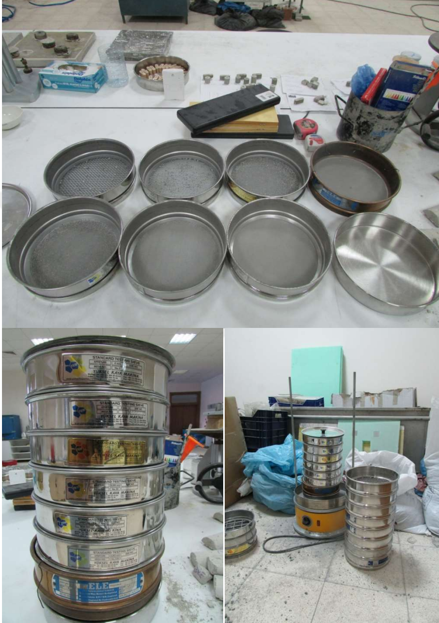
Şekil 3.6. Agregaların tane boyut dağılımını belirlemede kullanılan elek seti ve sarsma cihazı
