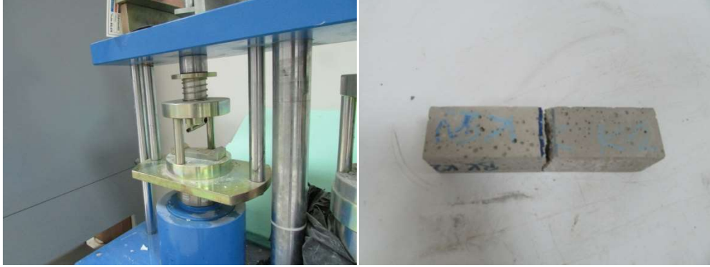
Şekil 3.15. Nokta eğilme deney düzeneği ve deney sonucu numune görünümü
