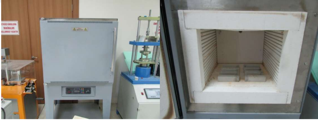
Şekil 3.22. Kül fırını ve numune dizilimi
