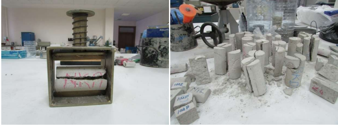
Şekil 3.17. Yarmada çekme dayanımı tayininde kullanılan yükleme çerçevesi ve deney sonucu numune görünüşleri
