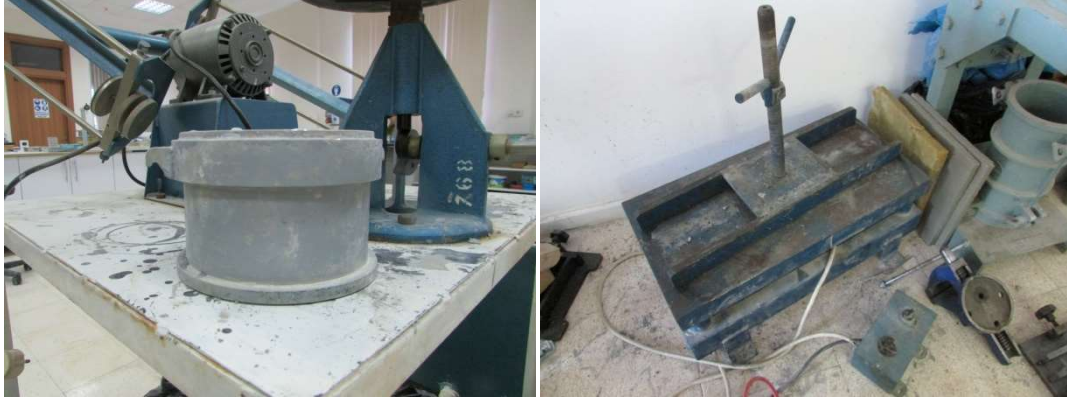
Şekil 3.10. Taze birim hacim ağırlık tayininde kullanılan kap ve titreşim cihazı
