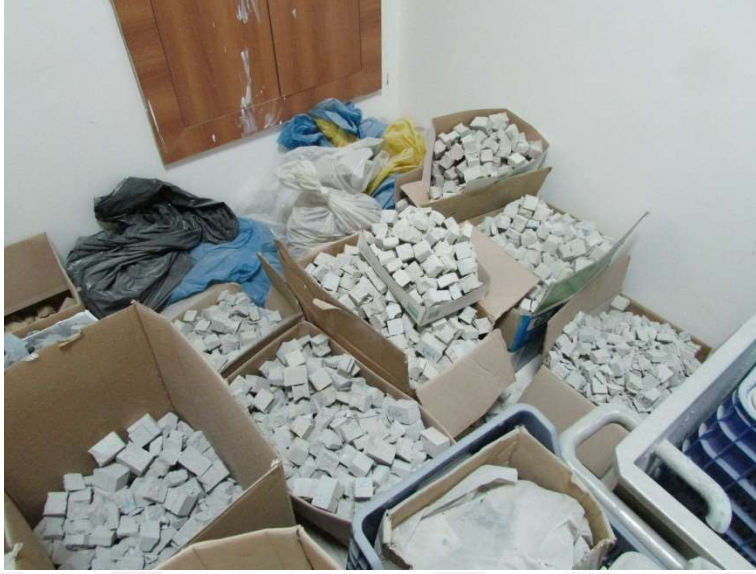
Şekil 3.19. Basınç dayanım testi sonucu kırılan numuneler
