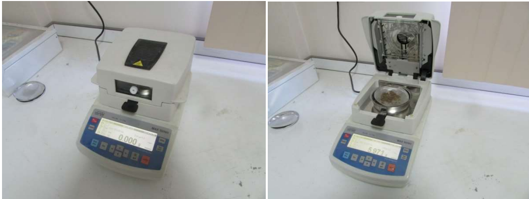
Şekil 3.5. Agregaların ağırlıkça yüzde su emme değerlerini hesaplamada kullanılan nem ölçer cihaz
