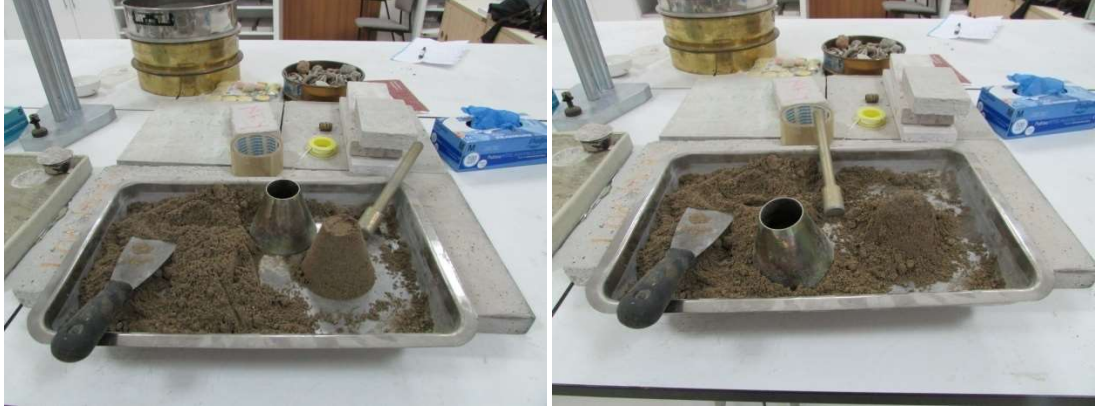
Şekil 3.4. Abrams konisi ile SDKY hal tayini
