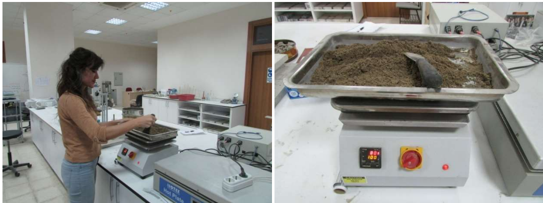
Şekil 3.3. Isıtıcı plaka yardımıyla agregaların SDKY hale getirilmesi
