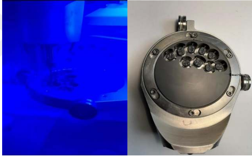
Şekil 27. CAD-CAM Mum Diskten Mum Örneklerin Kazınması.
