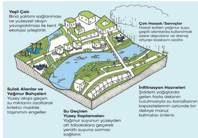
Şekil 2.25. Kentsel yağmur suyu hasadı (Abbott ve Ark., 2013)
