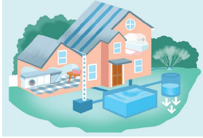
Şekil 2.29. Çatı yağmur suyu hasadı sistemi (YHD, 2022)
