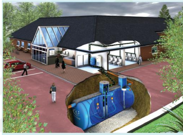
Şekil 2.26. Çatı yağmur suyu hasadı (YHD, 2022)
