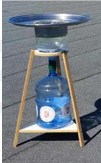
Şekil 3.3. Modifiye TS 2341 örnekleyici ve parçaları
