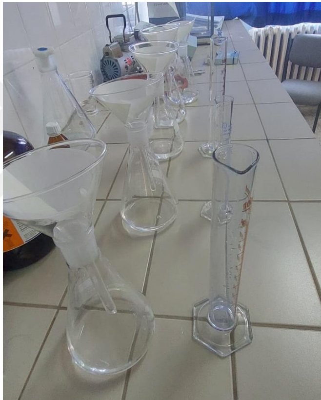
Şekil 3.10. Bulk ve kar örneklerine uygulanan süzme işlemi
