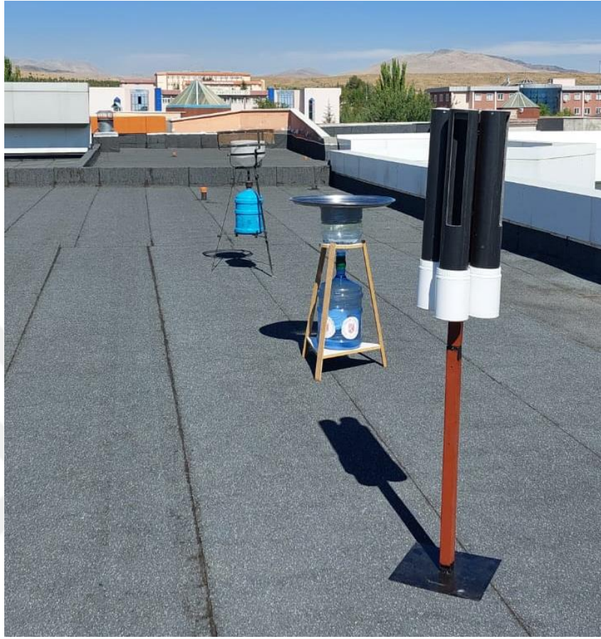
Şekil 3.4. Çöken Toz Örnekleyicinin Performans Ölçümleri
