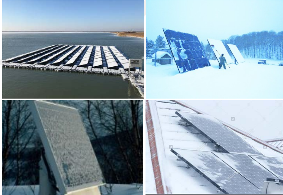
Şekil 5.1 Kar yağışı ve buzlanmanın FV panellere etkisi 6
