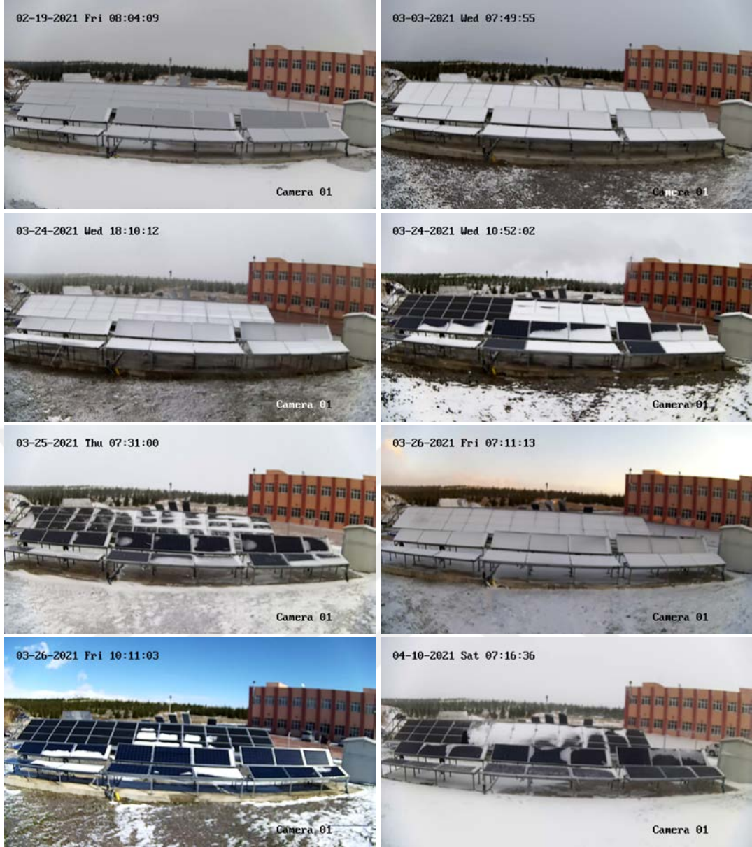
Şekil 6.3 FV tesislerin kurulu olduğu alanda kar yağışı ve buzlanmanın etkisi
