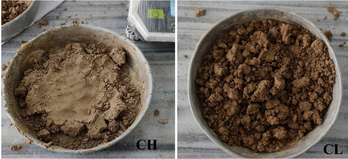
Şekil 4.20. Yüksek (CH)-PKF ve düşük (CL)-PKF plastisiteli killerin optimum su muhtevası karışımı
