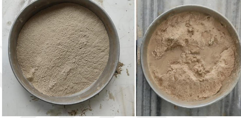
Şekil 4.18. Yüksek plastisiteli kilin PKF ile karışımı
