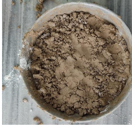
Şekil 4.26. Zemin-kireç optimum su muhtevası ile karışımı
