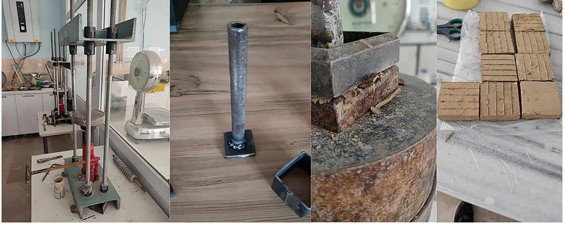
Şekil 4.22. Kesme kutusu deneyi için numunelerin hazırlanışı
