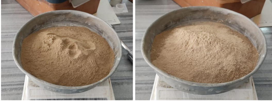
Şekil 4.19. Düşük plastisiteli kilin PKF ile karışımı
