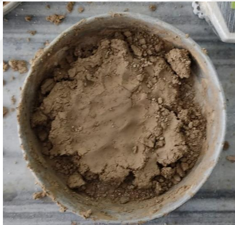
Şekil 4.24. Zemin-çimento optimum su muhtevası ile karışımı
