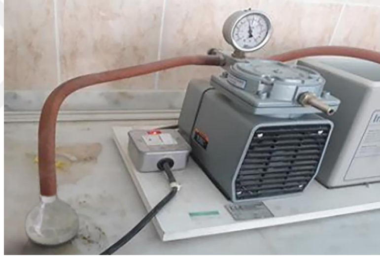
Şekil 4.11. Piknometre deneyi vakumlama işlemi
