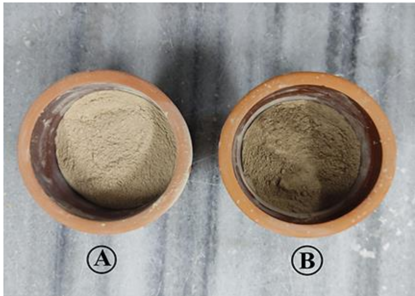
Şekil 4.17. 105 °C'de (A) ve 400 °C'de (B) kurutulan PKF
