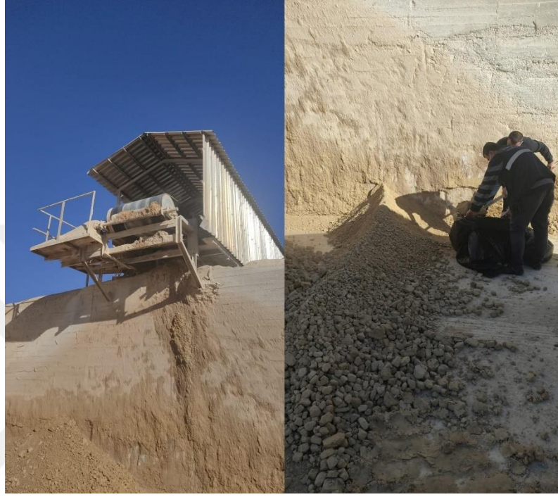
Şekil 4.3. Konya Şeker Fabrikası'ndan alınan preslenmiş atık kireç çamuru (PKF)
