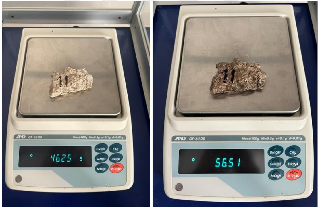
Numune 11 su emme deneyinden görseller
