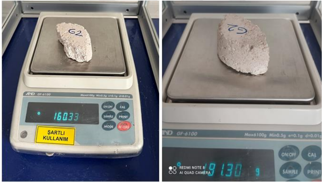
Grup 2 için önerilen onarım harcının kuru ve suya doymuş kütleleri
