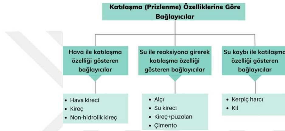
Şekil 2.4. Katılma özelliklerine göre bağlayıcı malzemeler (Artel ve Dibağ, 1969; Torracca, 1982; Ashurst ve Ashurst, 1988; Güleç, 1992; Borelli, 1999; Kozlu, 2010)
