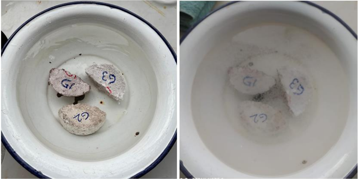
Onarım harçlarının su emme deneyinden görseller
