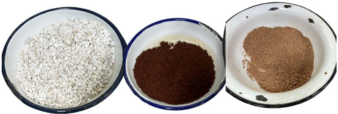
Şekil 5.6. Onarım harcı hazırlanırken kullanılan malzemeler
