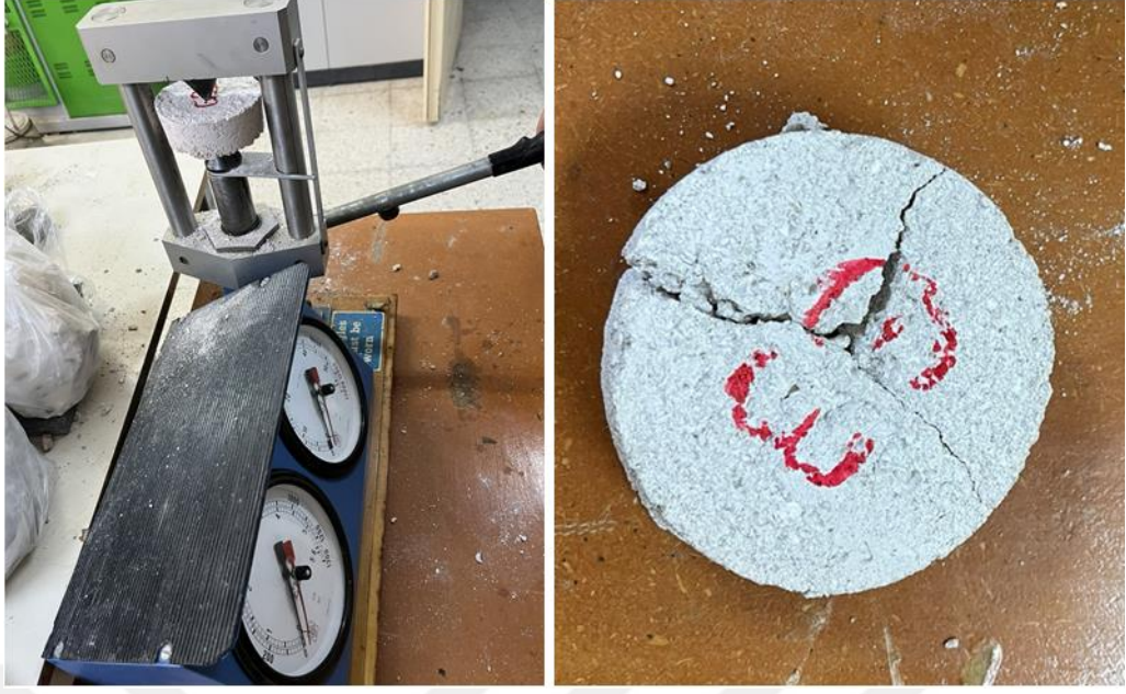
Grup 3 için önerilen onarım harcının nokta yük deneyi ve deney sonrası kırılmış hali
