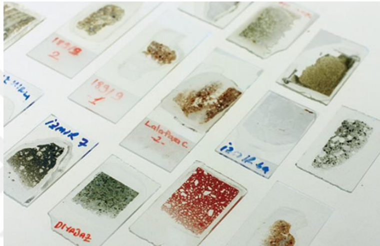
Şekil 4.30. İnceleme ve parlatma işlemleri sonrası ince kesitlerin görünüşü (KUDEB, 2009-2011)
