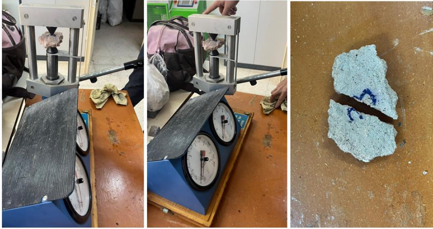
Numune 3 nokta yük deney görselleri
