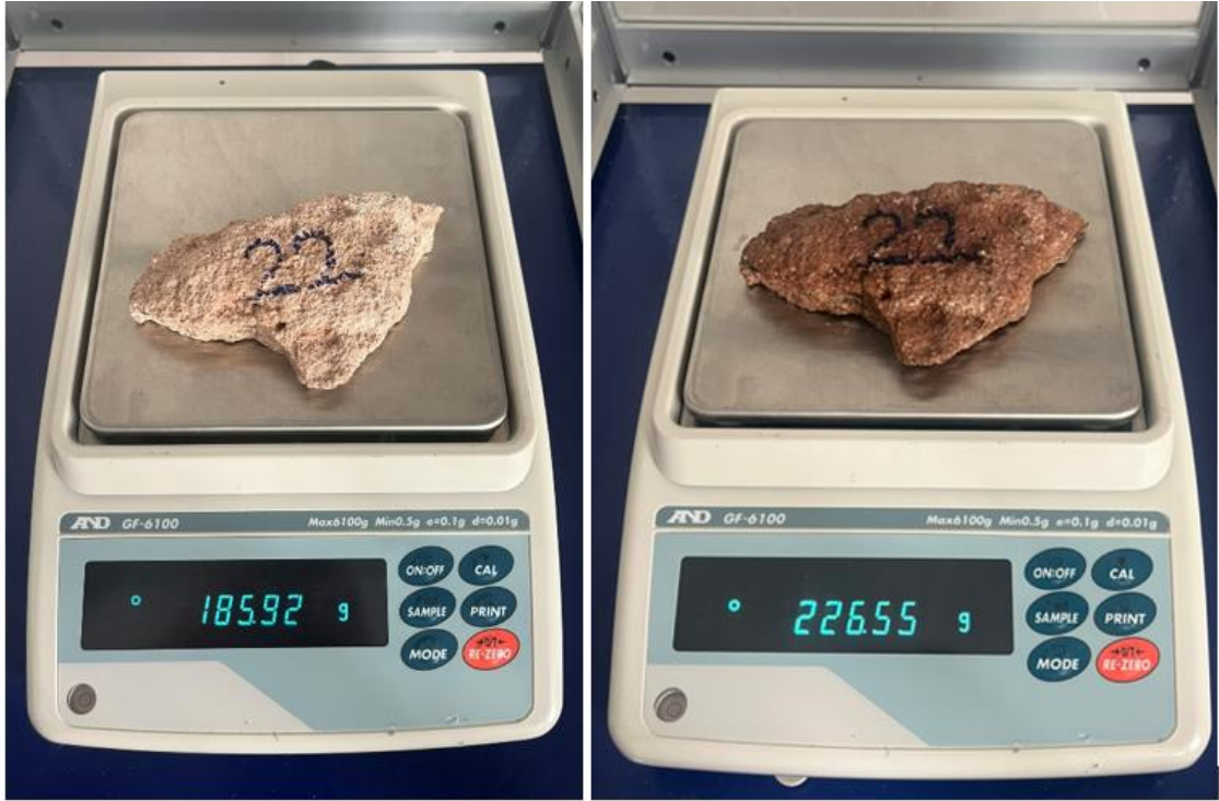
Numune 22 su emme deneyinden görseller
