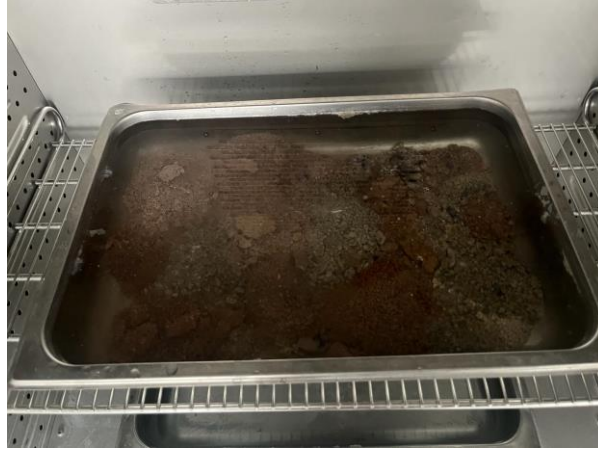
Şekil. 4.59. Donma çözünme deneyi sonrası harç malzemenin durumunun görseli
