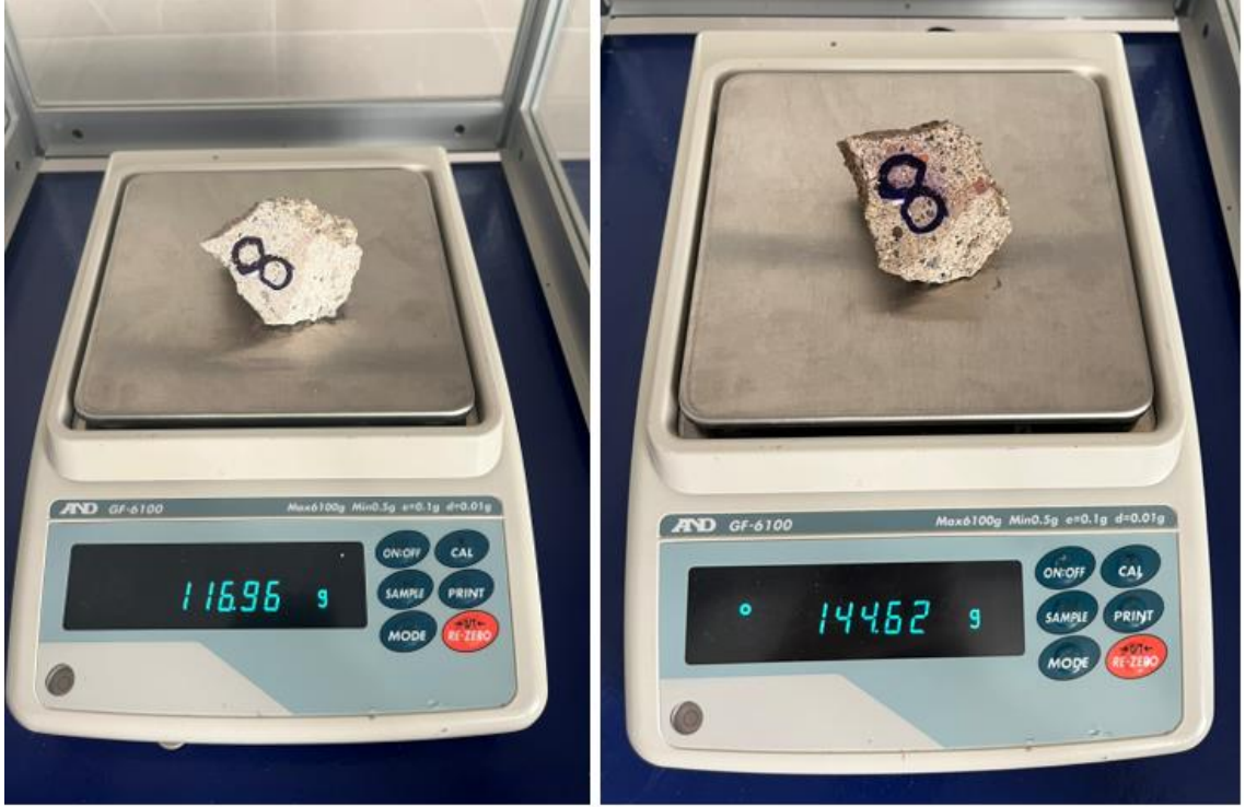
Numune 8 su emme deneyinden görseller
