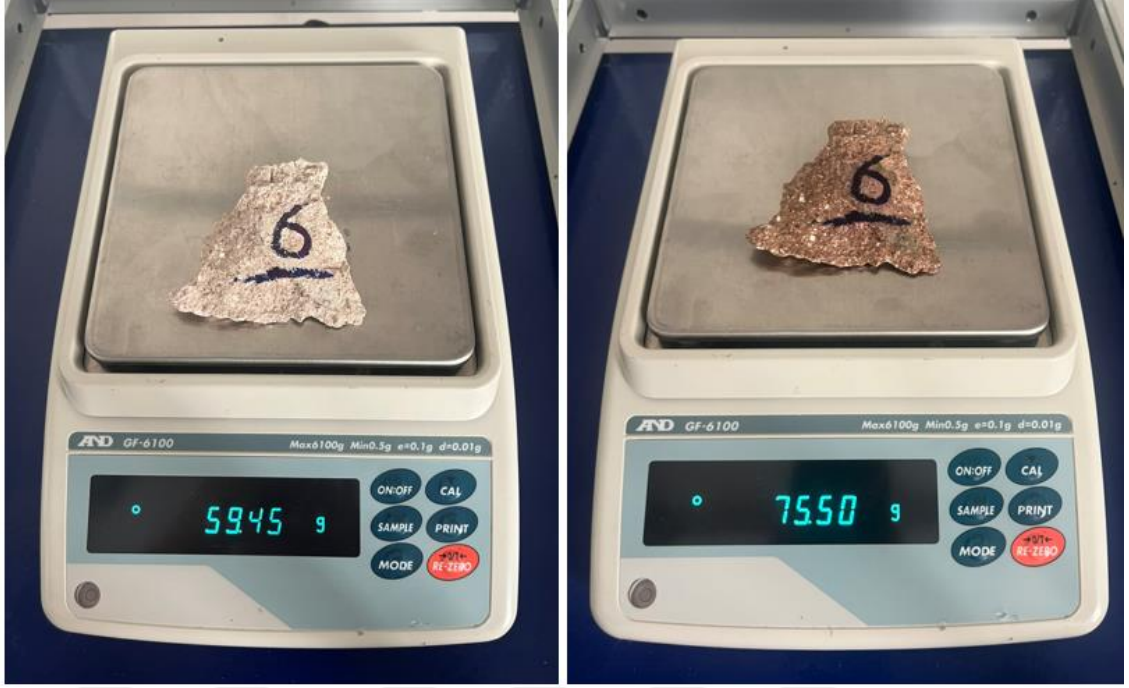
Numune 6 su emme deneyinden görseller
