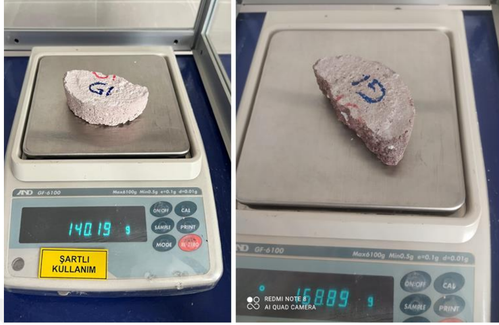
Grup 1 için önerilen onarım harcının kuru ve suya doymuş kütleleri
