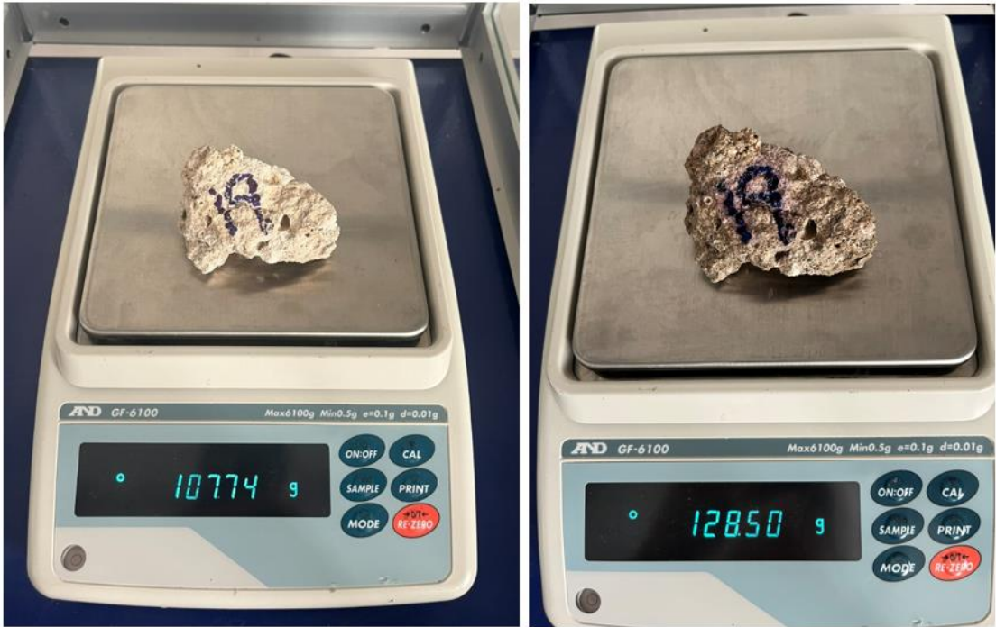
Numune 19 su emme deneyinden görseller
