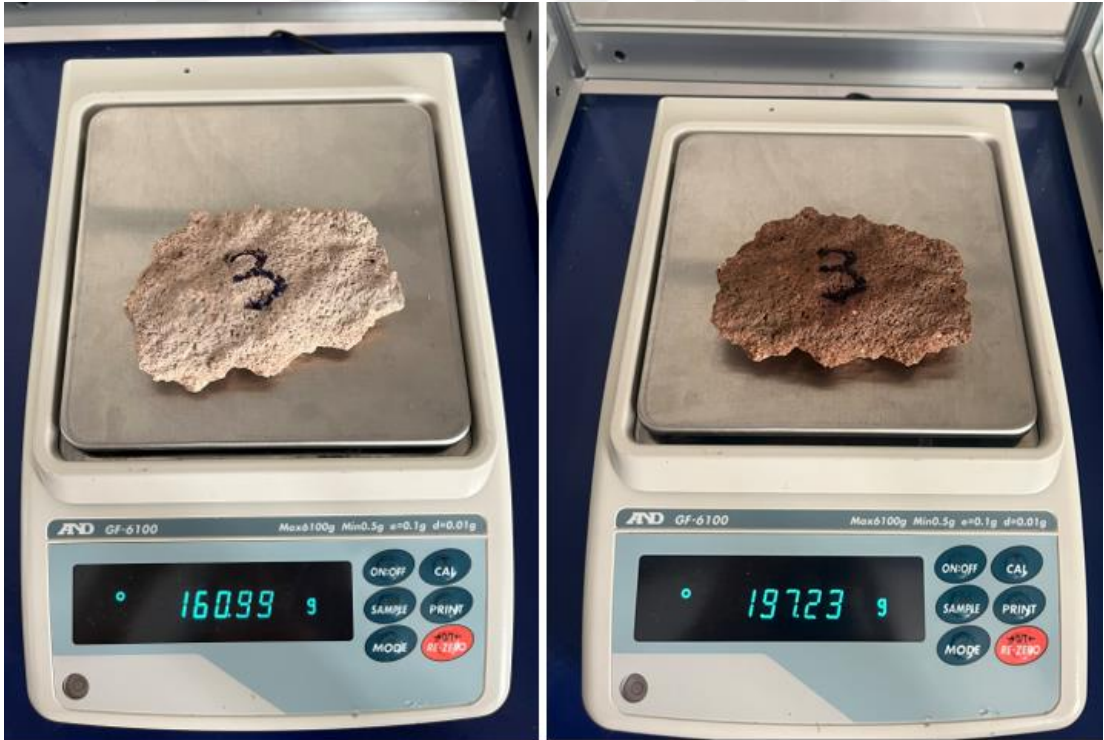
Numune 3 su emme deneyinden görseller
