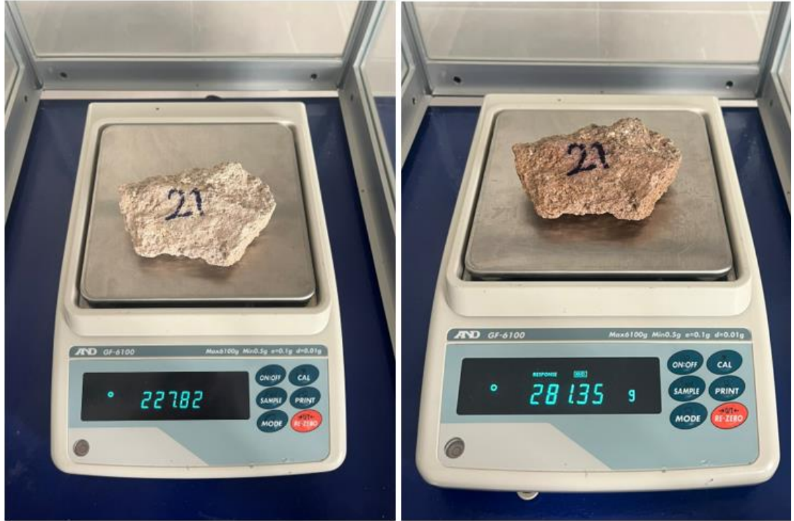
Numune 21 su emme deneyinden görseller
