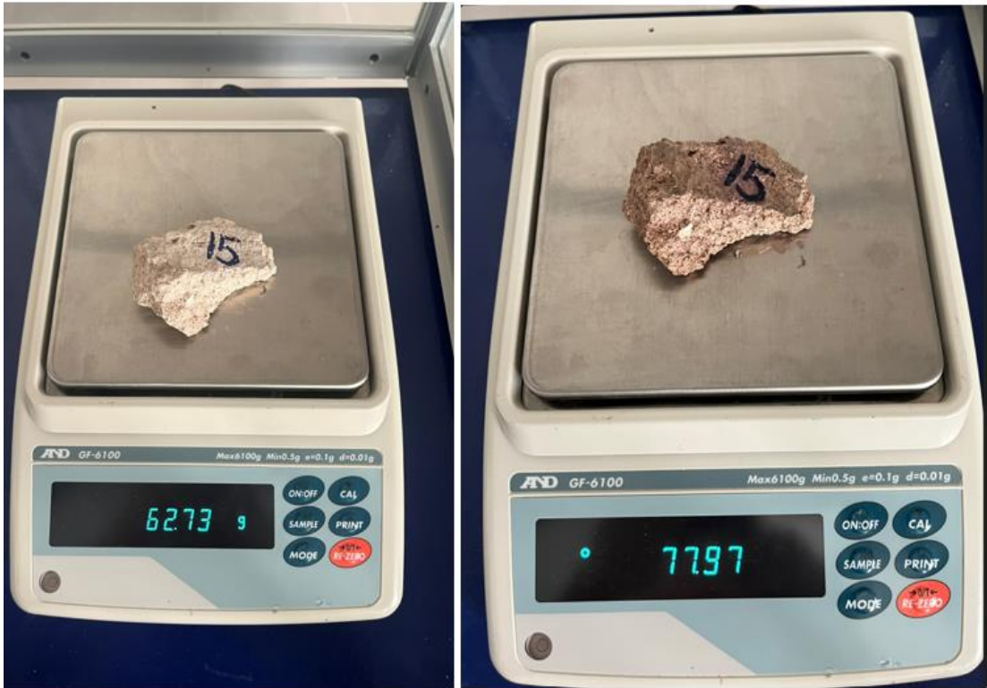
Numune 15 su emme deneyinden görseller
