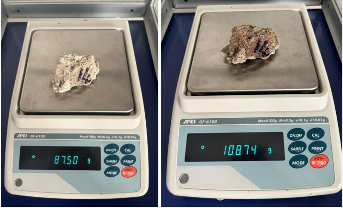
Numune 14 su emme deneyinden görseller
