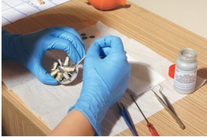
Şekil 4.26. Numunelerin iletkenliklerinin sağlanması için gümüş boya sürülmesi (KUDEB, 2009-2011).
