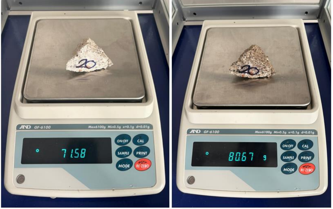
Numune 20 su emme deneyinden görseller
