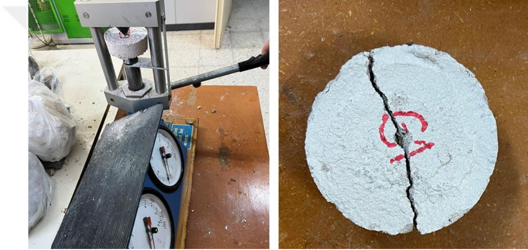
Grup 1 için önerilen onarım harcının nokta yük deneyi ve deney sonrası kırılmış hali
