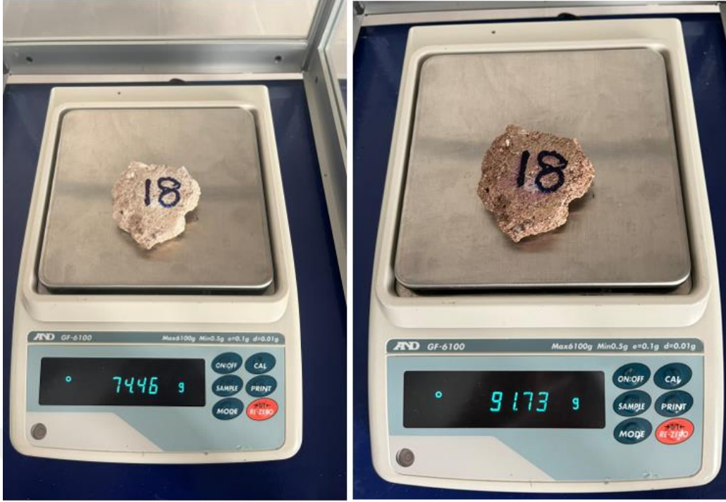
Numune 18 su emme deneyinden görseller
