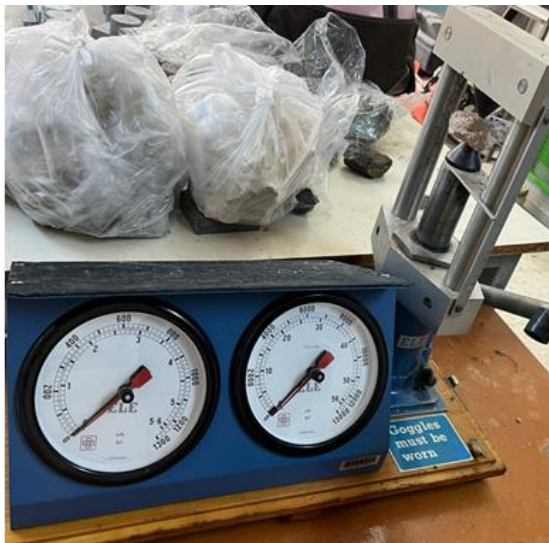
Numune 15 nokta yük deney görselleri
