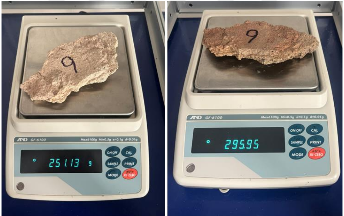
Numune 9 su emme deneyinden görseller
