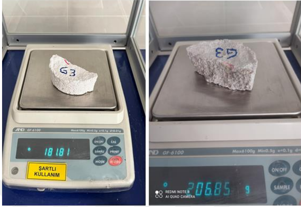
Grup 3 için önerilen onarım harcının kuru ve suya doymuş kütleleri
