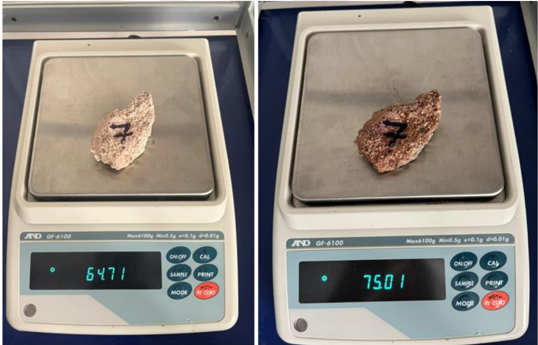
Numune 7 su emme deneyinden görseller
