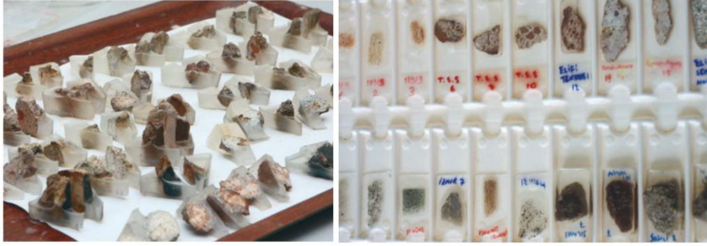
Şekil 4.28. Epoksi reçine ile harç örneklerinin kalıpta dondurulmuş hali (KUDEB, 2009-2011).
