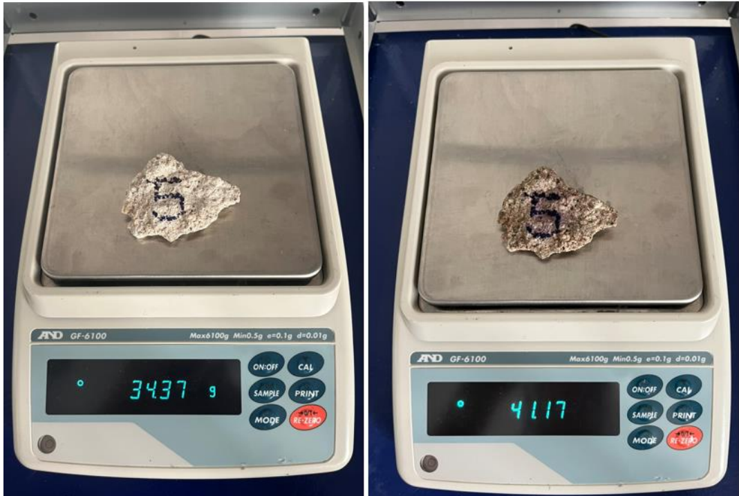
Numune 5 su emme deneyinden görseller
