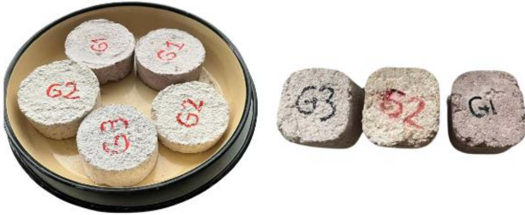
Şekil 5.10. Hazırlanan onarım harçları
