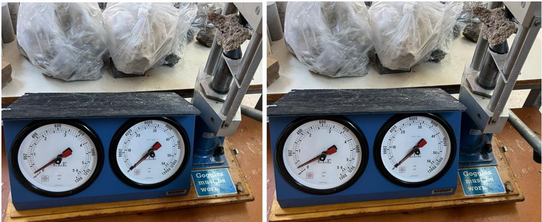
Numune 10 nokta yük deney görselleri
