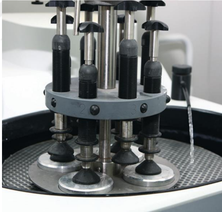
Şekil 4.27. Kesitlerin parlatılması (KUDEB, 2009-2011).
