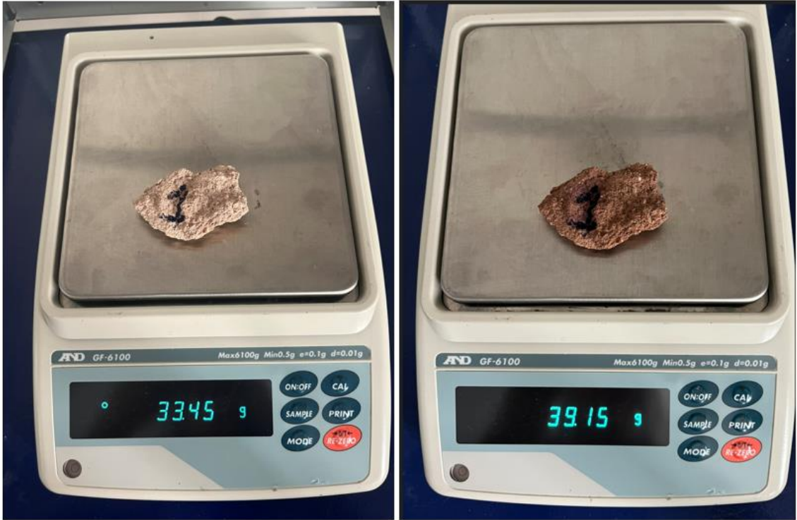
Numune 1 su emme deneyinden görseller
