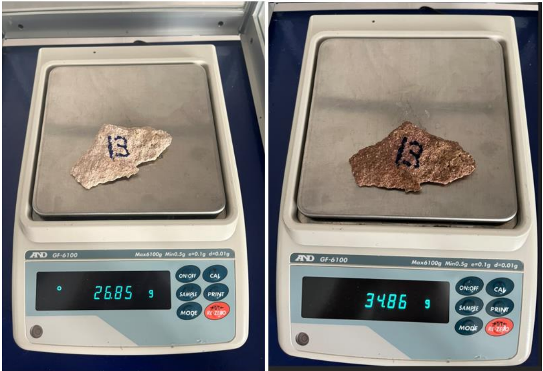
Numune 13 su emme deneyinden görseller
