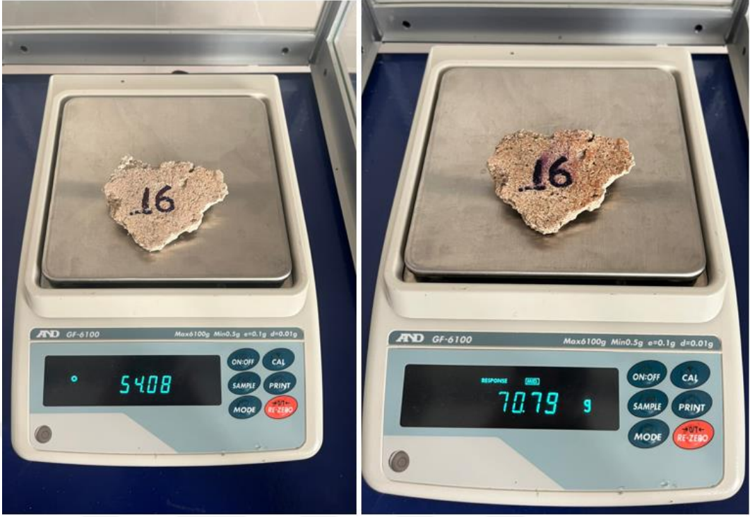
Numune 16 su emme deneyinden görseller
