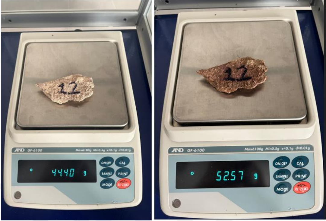
Numune 12 su emme deneyinden görseller
