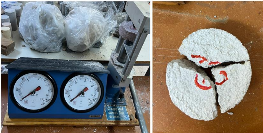
Grup 2 için önerilen onarım harcının nokta yük deneyi ve deney sonrası kırılmış hali
