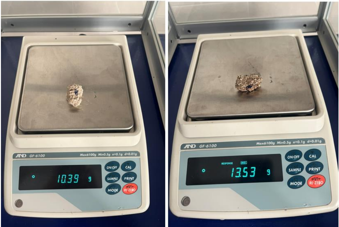
Numune 17 su emme deneyinden görseller
