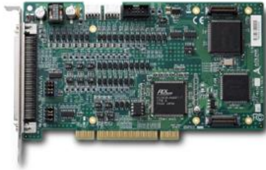
řekil 3.12. PCI-8154 hareket kontrol kartı.
