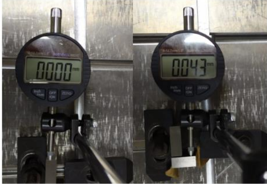
Şekil 5.2. Komparatörün X eksenindeki hassasiyet ölçümü.
