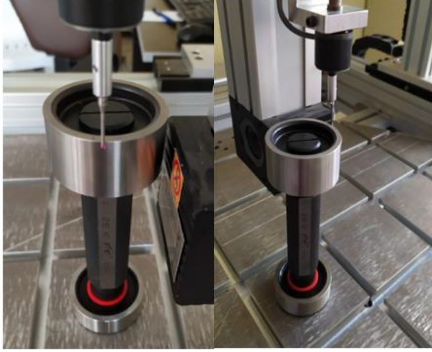
Şekil 5.11. Geçer geçmez master ölçüm deneyi.
