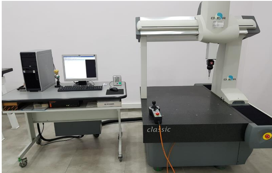
Şekil 5.18. Hexagon Dea CMM cihazı.
