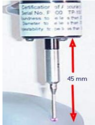
Şekil 3.10. Z eksenine bağlanan temaslı prob.
