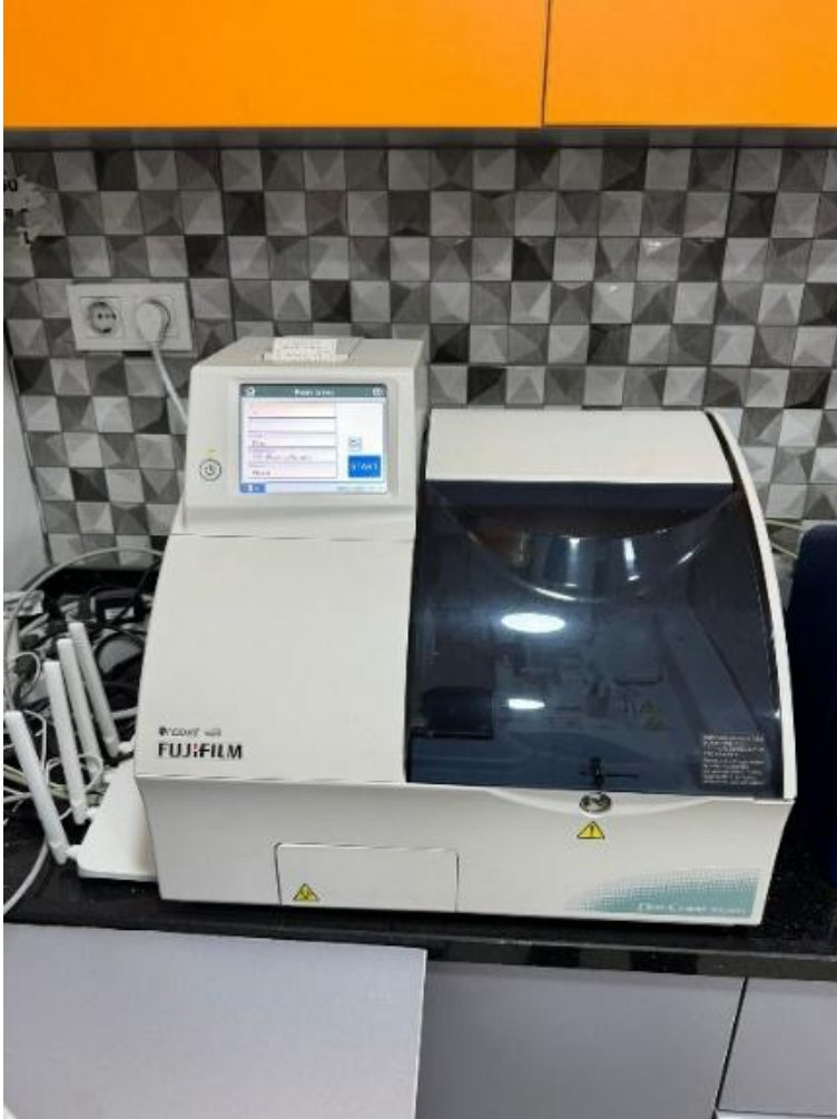
Resim 2.3: CK-MB ölçümünün yapıldığı FUJI DRI-CHEM NX500i Biyokimya Cihazı
