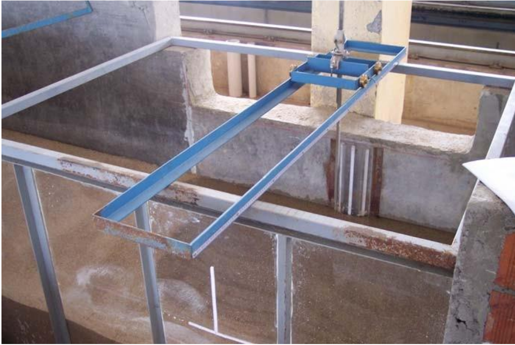
Şekil 4.2. Oyulma deliğinin koordinatlarını ölçmek için kullanılan ölçüm ekipmanı (Köse, 2007).
