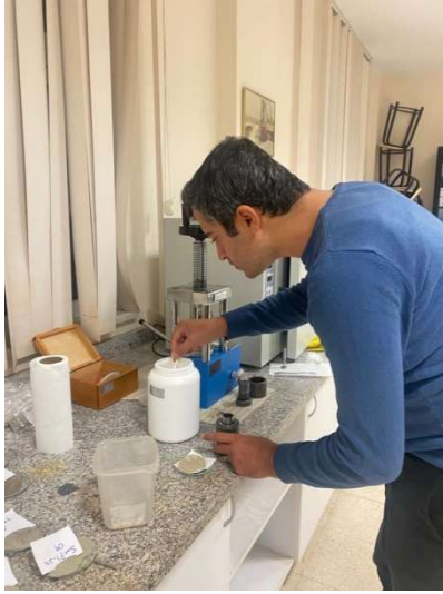
Şekil 3.6. Numunelerin Borik Asit ile Pellet Haline Getirilmesi
