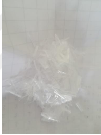
Resim 3.5 Çalışmada kullanılan polipropilen lif.
