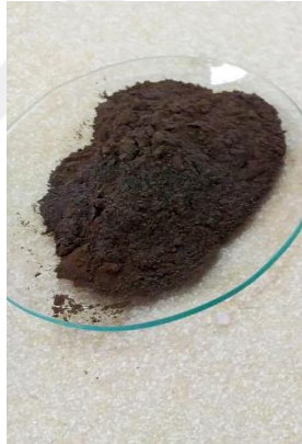
Resim 3.3 Çalışmada kullanılan uçucu kül.
