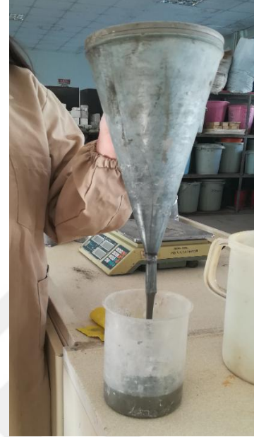
Resim 3.12 Marsh Konisi deneyi.
