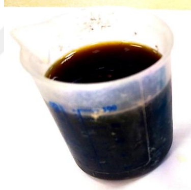
Resim 3.4 Çalışmada kullanılan süper akışkanlaştırıcı.
