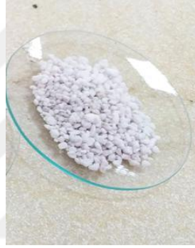
Resim 3.8 alıřmada kullanılan genleřtirilmiř perlit.
