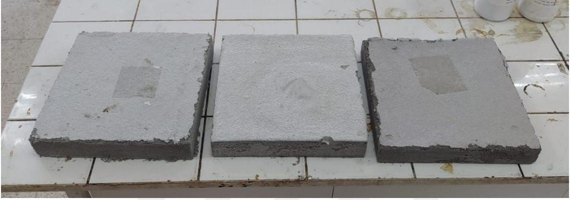
Resim 3.15 Çalışmada üretilen ısı yalıtım plaka örnekleri.
