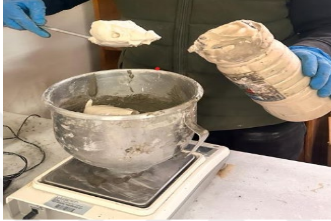
Şekil 3.6: Köpüğün ıslak karışıma ilave edilmesi
