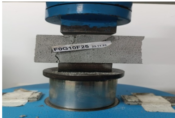
Şekil 3.13: Köpük betonların basınç dayanımı tespiti
