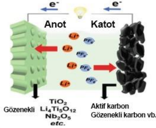
Şekil 3. Hibrit süperkapasitörün şematik gösterimi (Lim vd., 2016).
