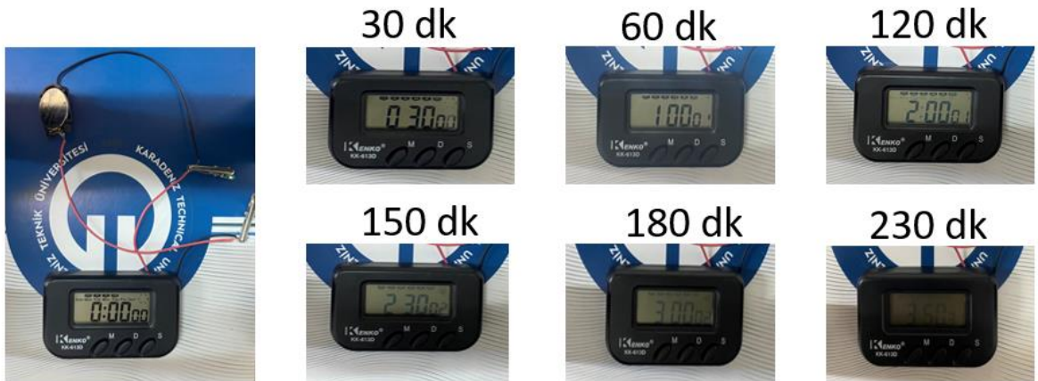
Şekil 56. NiCoP@EG ve AC@EG kullanılarak oluşturulan CR2032 tipi asimetrik süperkapasitör ve dijital kronometre ile oluşturulmuş elektriksel devrenin fotoğrafı
