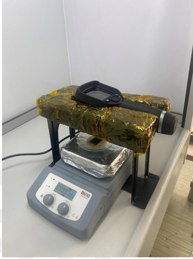
Şekil 15. Termal ölçümler sırasında kullanılan düzeneğe ait fotoğraf
