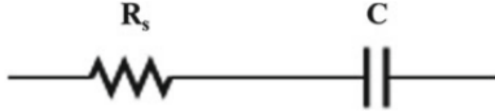
Şekil 6. Süperkapasitörün frekansa bağlı davranışını tanımlamak için kullanılan şematik gösterim
