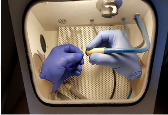
Şekil 3.12. Kumlama cihazında örneklerin kumlanması
