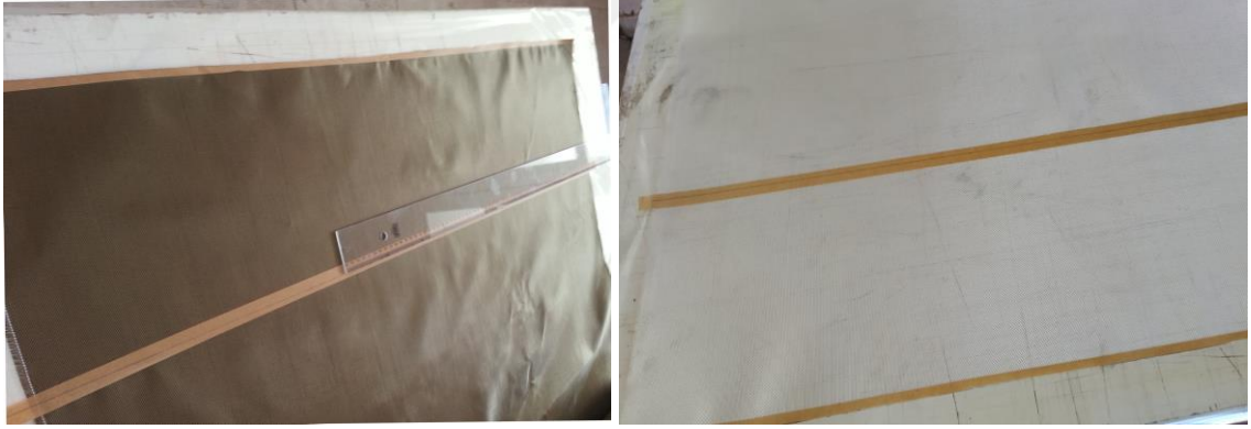
a) bazalt fiber plain dokuma kumaş kesimi, b) cam fiber plain dokuma kumaş kesimi
