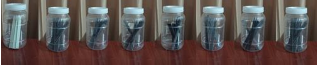
Şekil 3.6. Numunelerin tuzlu suda bekletilmesi
