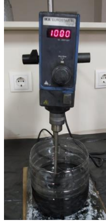
Şekil 3.3. Epoksi ve sertleştiricinin karışımı
