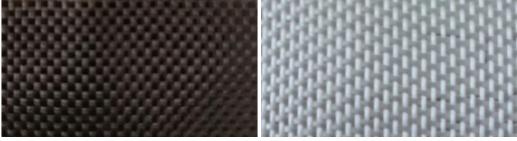
Şekil 3.1. a) bazalt fiber plain dokuma kumaş, b) cam fiber plain dokuma kumaş
