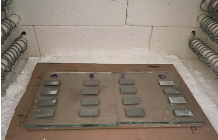
Şekil 3.6 Kaplanan numunelere ısıtılma işlemi uygulanması.
