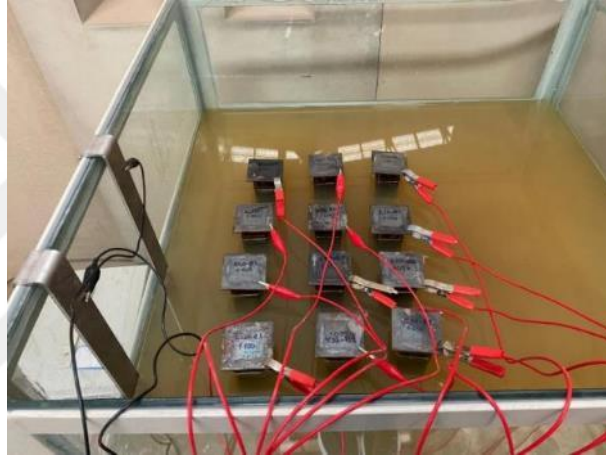
Şekil 3.19. Hızlandırılmış korozyon test düzeneği
