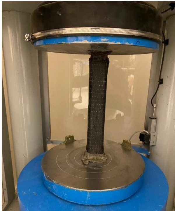
Şekil 3.38. Güçlendirilmiş profil basınç testi
