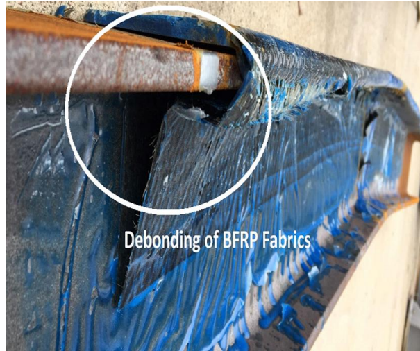
Şekil 2.3. Fazla katmanlı onarımlar için bağ açma [38]
