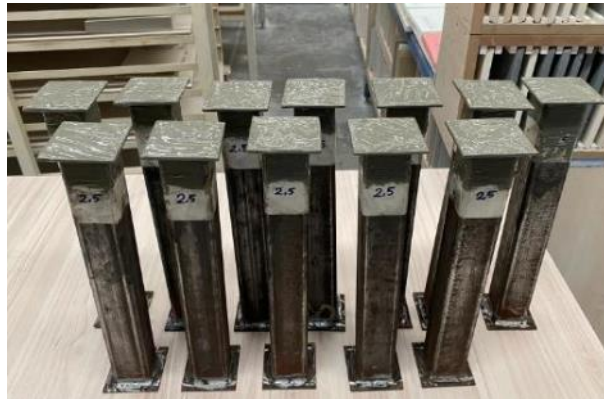
Şekil 3.17. Korozyon hasarına uğrayacak kısımlar
