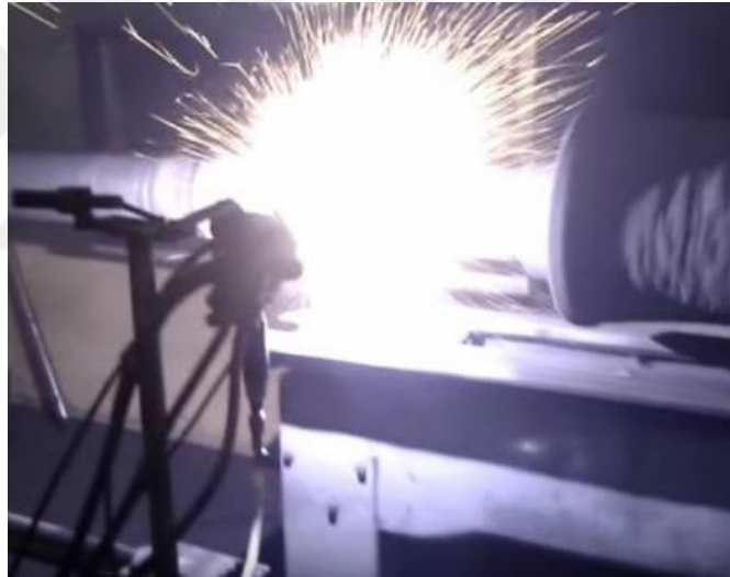
Şekil 2.56. Püskürtme yöntemi ile metalik kaplama [1]
