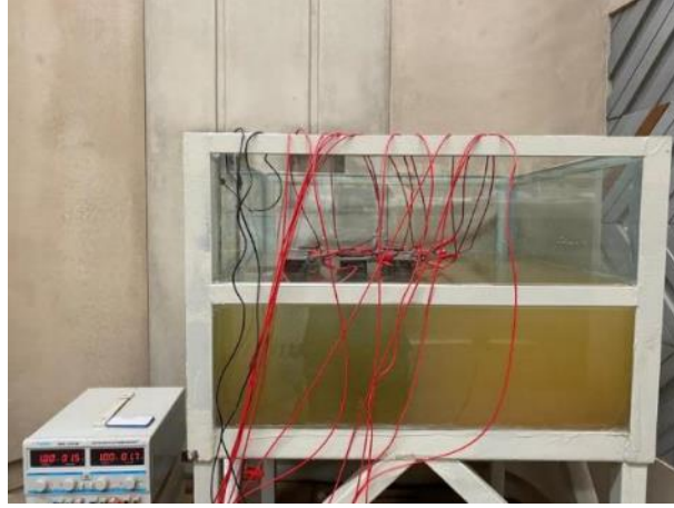
Şekil 3.18. Hızlandırılmış korozyon test düzeneği
