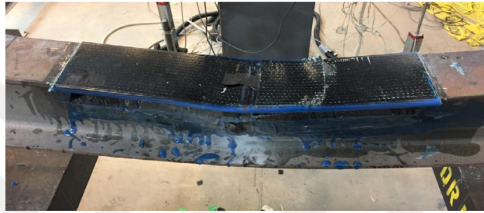
Şekil 2.5. Eğilme deneyi sonrası çelik profil [39]
