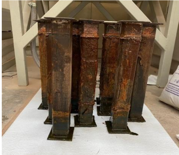
Şekil 3.25. Hızlandırılmış korozyon havuzundan çıkarılan profiller
