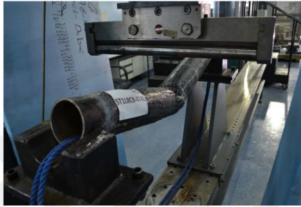
Şekil 2.9. CFRP ile güçlendirilmiş numunelerin eğilme testi [20]
