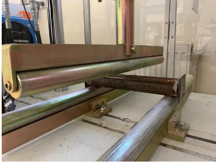
Şekil 3.40. Güçlendirilmemiş profil eğilme testi
