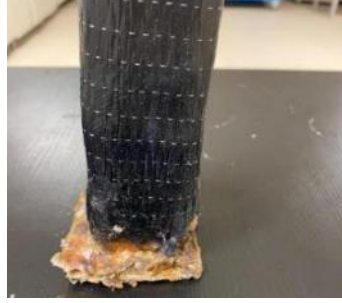
Şekil 4.14. CFRP ile güçlendirilmiş %10 korozyon hasarlı profilin basınç testi sonrası
