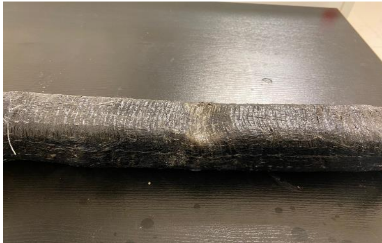
Şekil 4.29. BFRP ile güçlendirilmiş %20 korozyon hasarlı profilin eğilme testi sonrası
