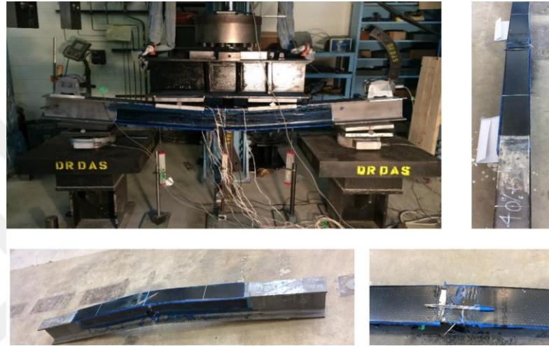
Şekil 2.14. CFRP ile güçlendirilmiş profillerin eğilme testi sonrası [53]
