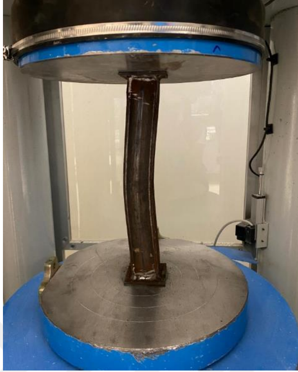
Şekil 3.37. Güçlendirilmemiş profil basınç testi
