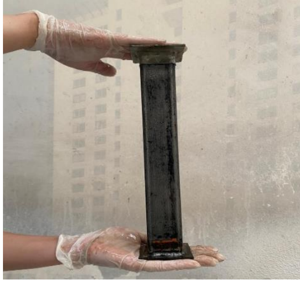
Şekil 3.26. Korozyon atıklarından temizlenen profil
