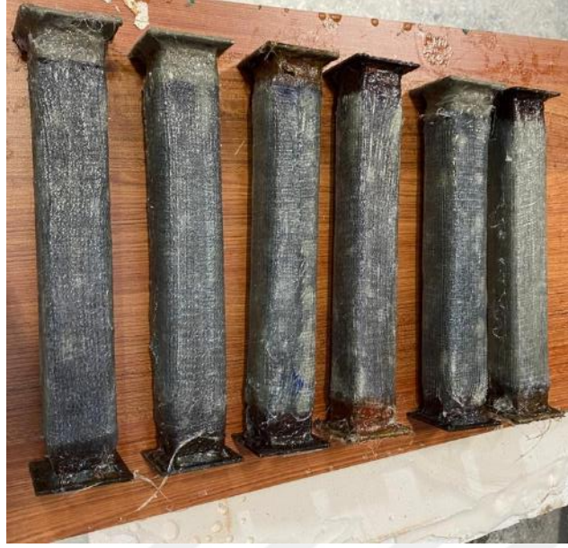
Şekil 3.34. GFRP ile güçlendirmesi tamamlanmış profiller
