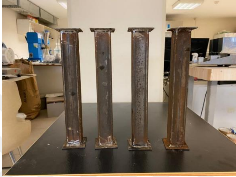
Şekil 3.3. Korozyon hasarına uğramayan profil örneği
