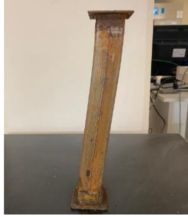
Şekil 4.1. Kütlege %20 korozyon hasarlı profil basınç testi sonrası
