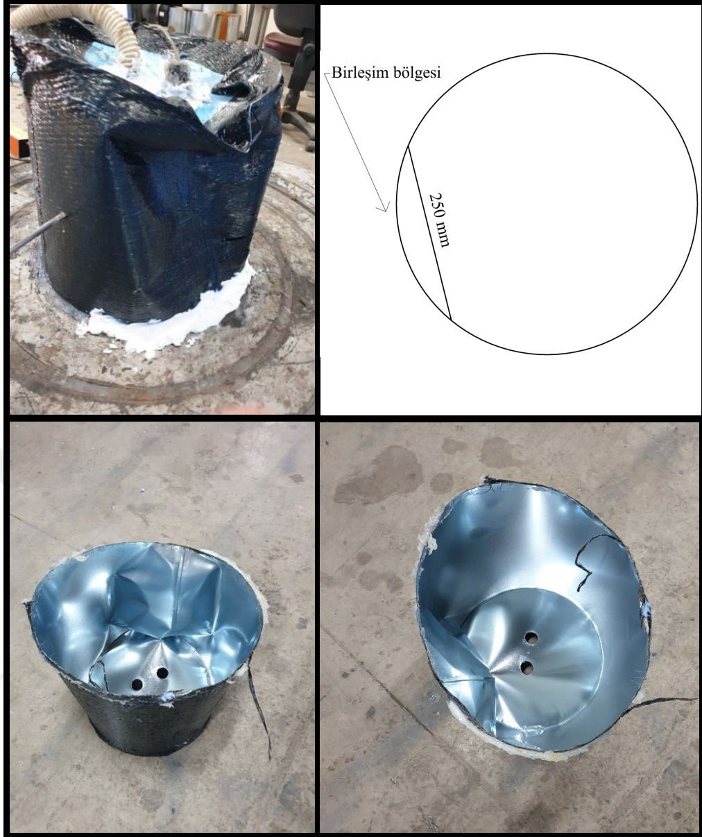
Şekil 4.5. Burkulma deneyi sonrası Exp2-CFRP numunesi
