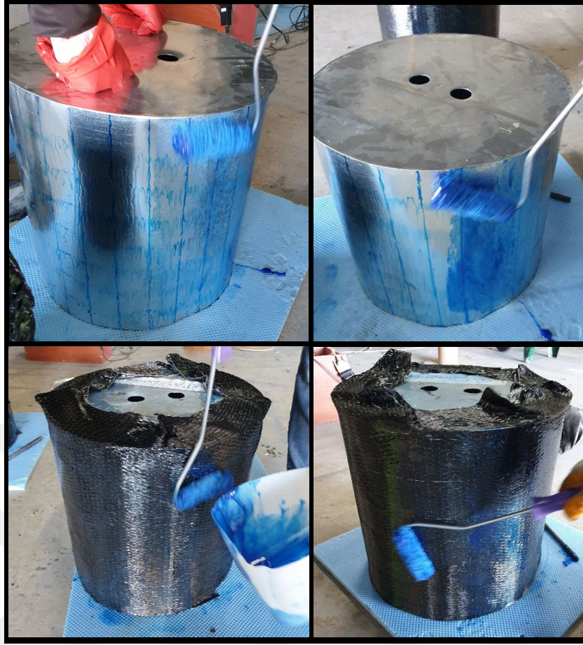
Şekil 3.11. Numunelere CFRP kaplama işlemi
