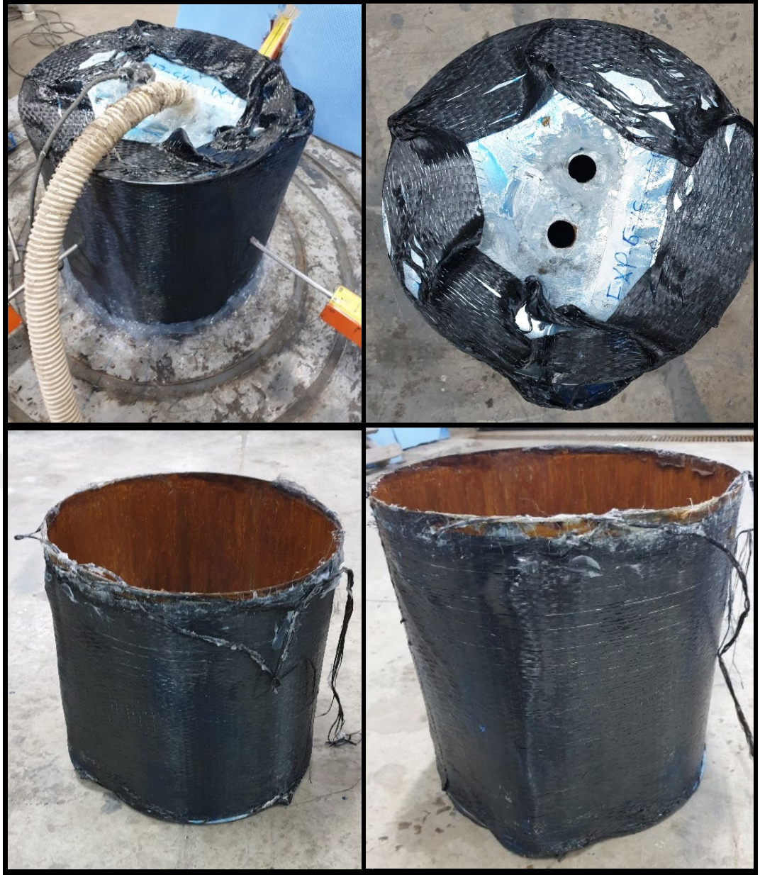
Şekil 4.13. Burkulma deneyi sonrası Exp6-%5-CFRP numunesi
