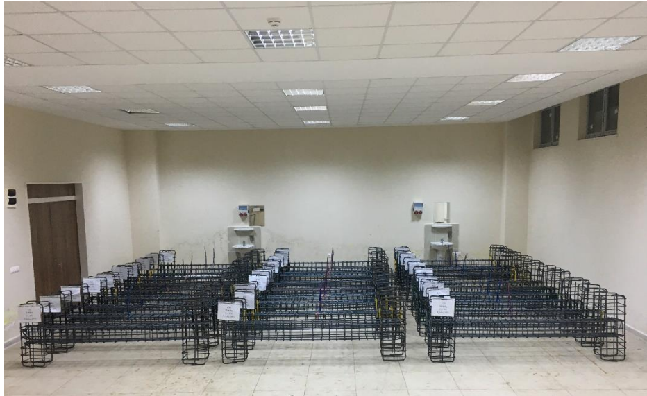
Şekil 4.2. Betonarme kolonların donatı kafesine bağlanan bakır teller örnek çalışma
