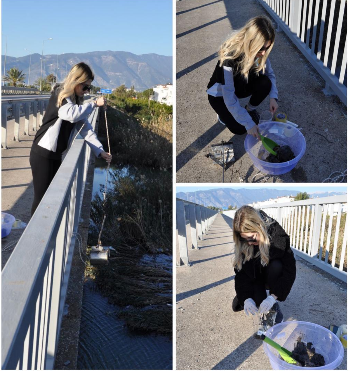
Fotoğraf 3.3. Yatak Örneğinin Alınma Aşamaları
