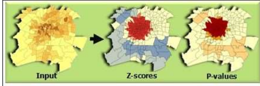
Şekil 2.11. Sıcak nokta analizi z skoru ve p değeri ile ilgili kümelenme haritası [193].
