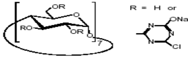
Şekil 1.17 Monoklortriazin-β-siklodekstrinin moleküler yapısı (Wacker- Chemie GmbH)
