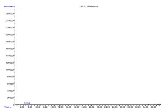
Şekil 3.9 Siklohegzilamin buharına maruz kalmış ve 10 yıkama yapılmış kumaşın GC-MS kromatogramı
