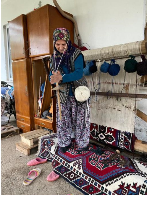
Görsel 3.78 Bükme Yardımı ile İki Telin Döndürülerek Eriç Yani Tek İp Haline Gelmesi
