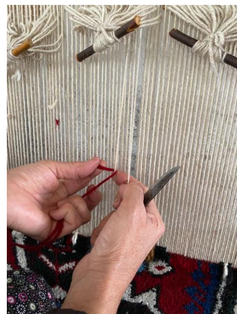
Görsel 3.76 Tellere Atılan Düğümü Kesmek İçin Kullanılan Bilenmiş Halı Bıçağı
