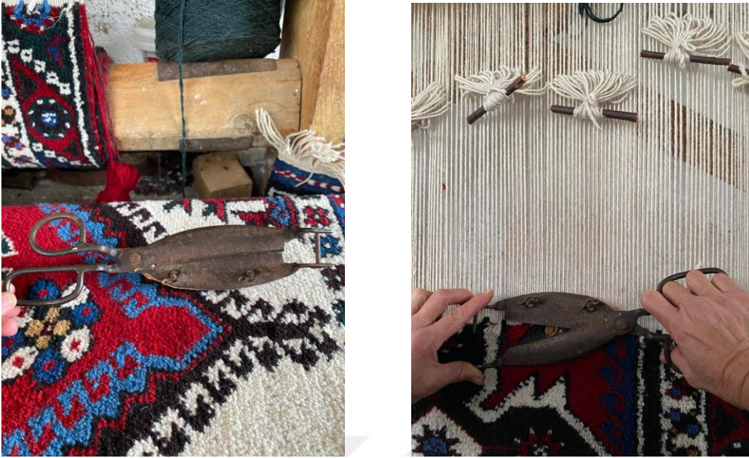
Görsel 3.77 Halının Kalınlığını Eşit Bir Şekilde Kesen İki Elle Kullanılan Ayarlanabilir Halı Makası
