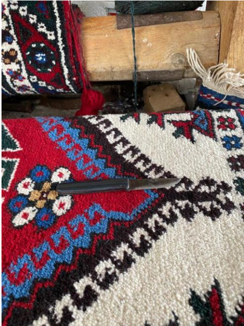
Görsel 3.76 Tellere Atılan Düğümü Kesmek İçin Kullanılan Bilenmiş Halı Bıçağı
