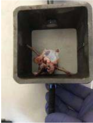
Resim 11: Çekme testi sırasında omuru sabitleyen çelik profil
