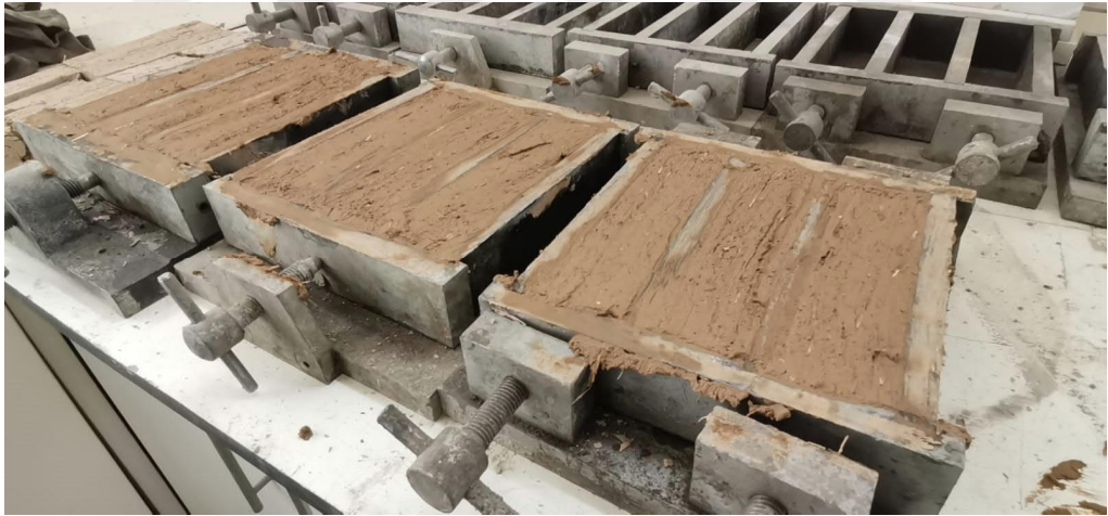
Şekil 3.13. 40:x40x160 mm boyutlarındaki prizmatik kalıplara yerleştirilen numuneler
