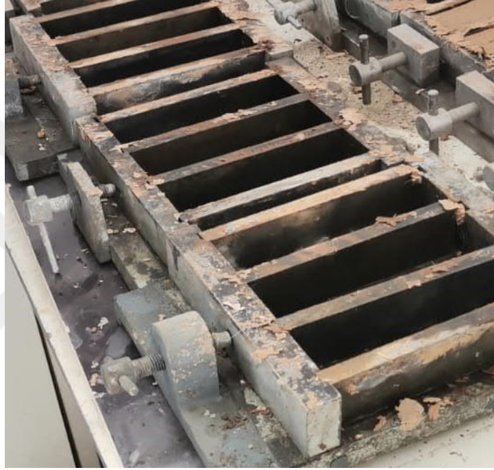
Şekil 3.9. 40x40x160 mm boyutlarındaki prizmatik kalıplar
