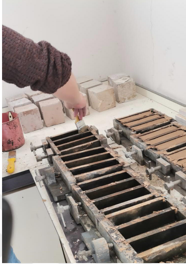
Şekil 3.11. Kalıpların numune yerleştirilmeden önce yağlanması
