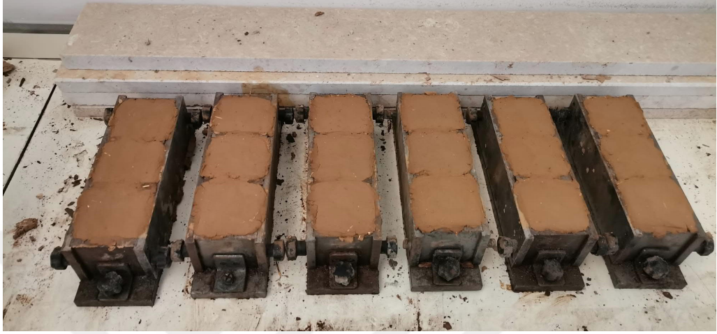
Şekil 3.12. 50x50x50 mm boyutlarındaki küp kalıplara yerleştirilen numuneler
