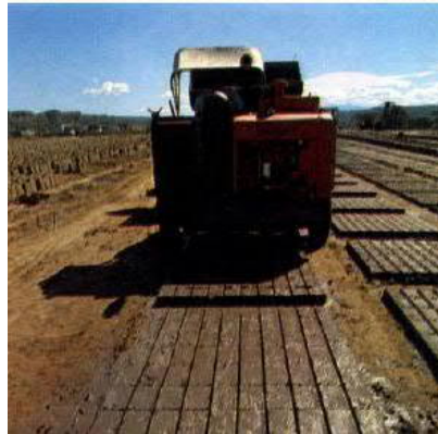
Şekil 2.35. Günlük 20.000 adet kerpiç üretimi yapabilen makine/New Mexico, (Gül, 2011)
