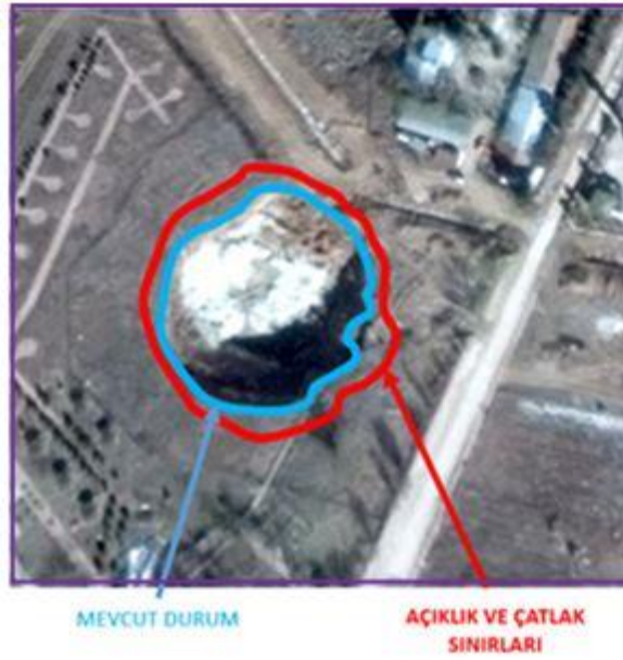
Şekil 3.13: Çöküntünün mevcut çatlak ve açıklıklar doğrultusunda ilerlemesi durumunda muhtemel senaryo.
