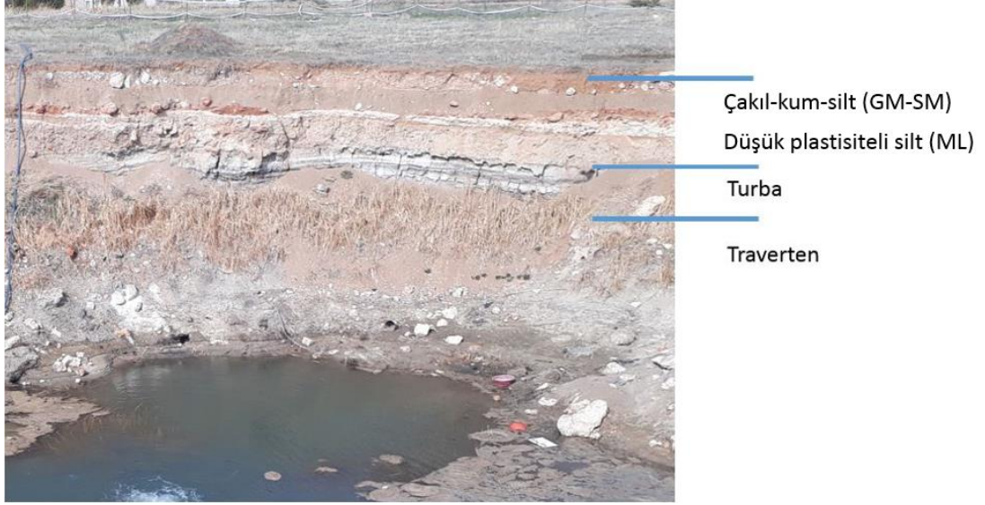
Şekil 3.4: KJA'da çöküntü alanının stratigrafisi.
