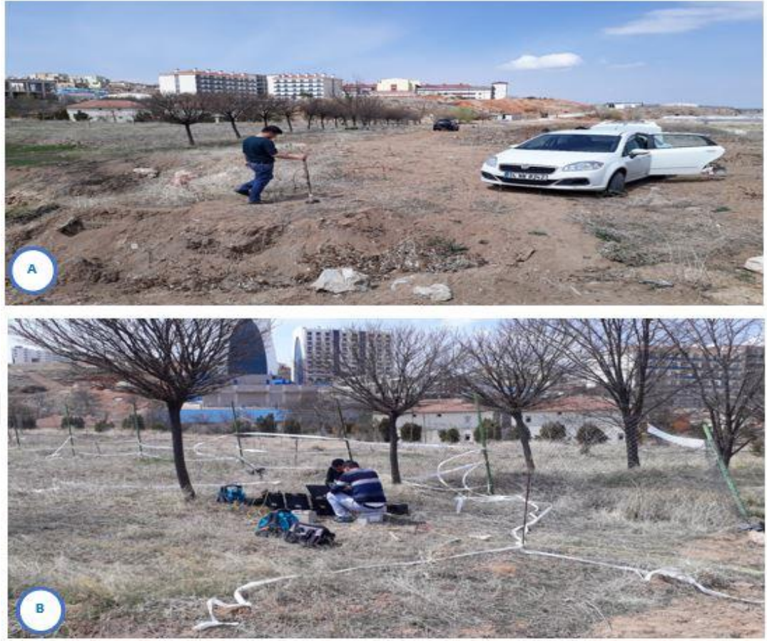
Şekil 3.43: KJA’da MASW ve DES (A) ve ERT (B) çalışmaları.
