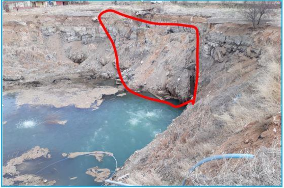
Şekil 3.14: Çöküntü alanında 2016 yılı sonlarında meydana gelen kopma.
