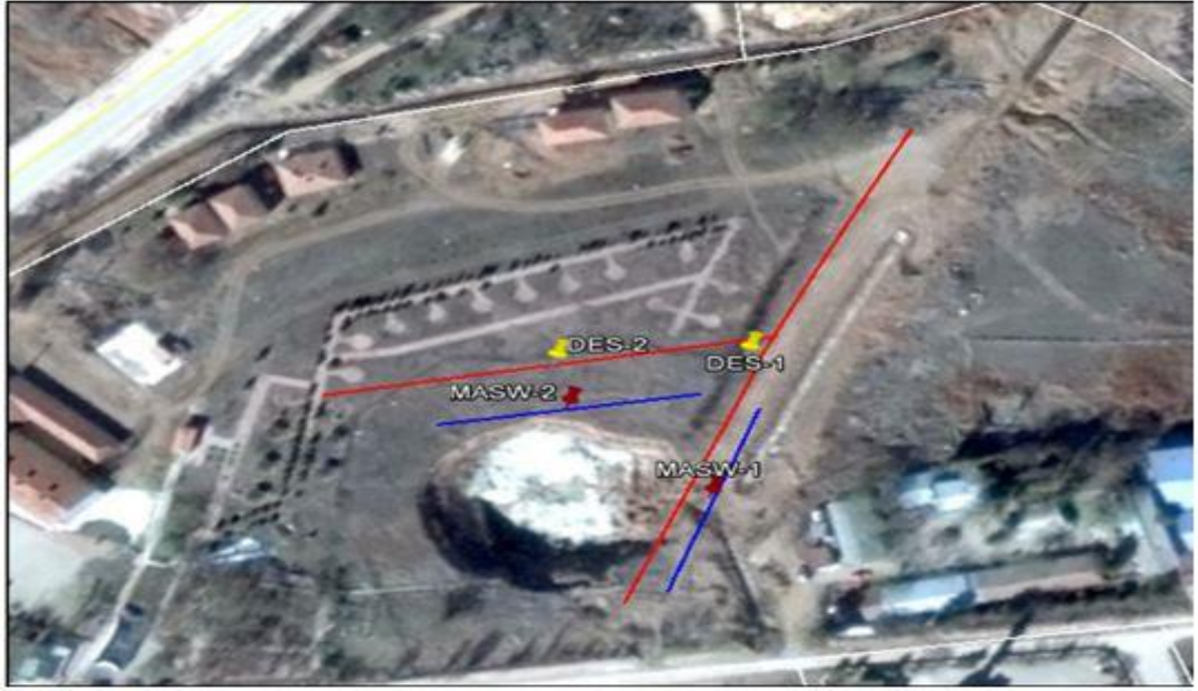
Şekil 3.41:KJA'da MASW ve DES ölçümlerine ait lokasyon görüntüsü.
