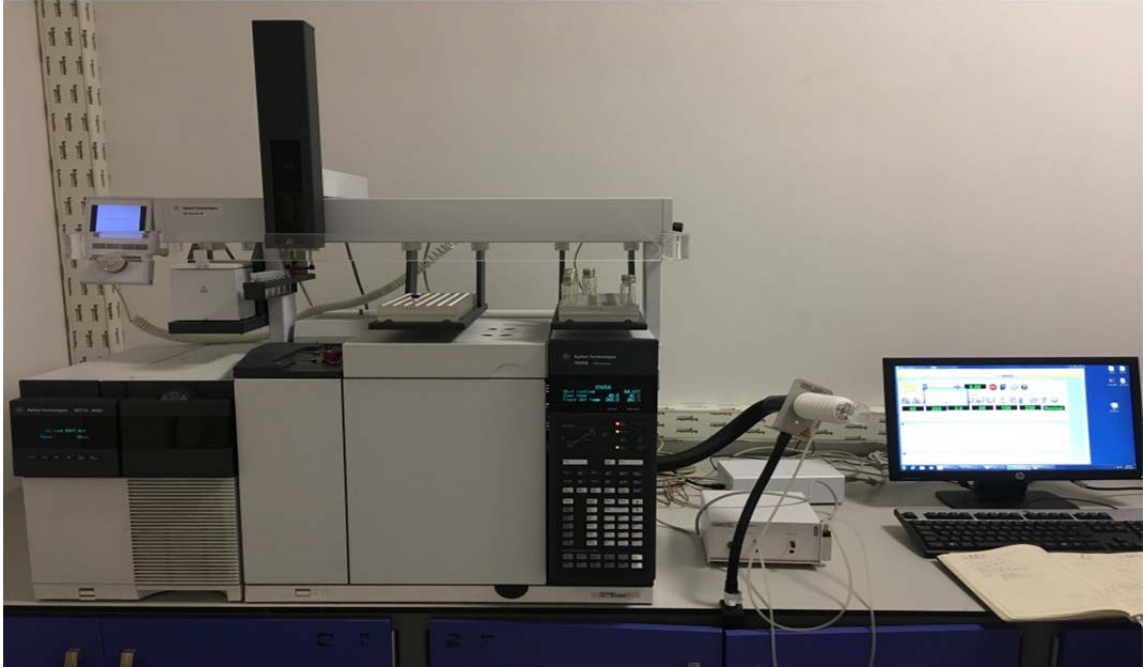
Şekil 3.3. Aroma maddelerinin miktarının tespiti ve tanımlanması için kullanılan “Agilent 7890B” marka alev iyonlaşma dedektörlü (FID) gaz kromatografisi (GC) ve “Agilent 5977A MSD” kütle spektrometresi
