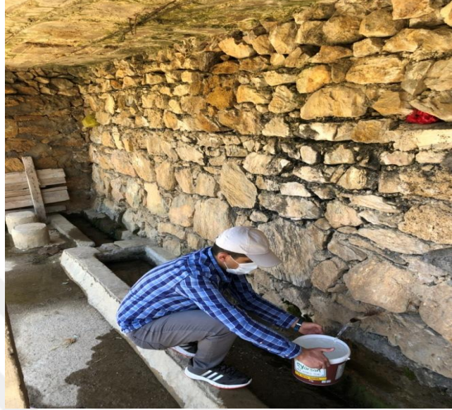
Şekil 2.1. M-3 kaynağı belirli hacim yöntemi ile debi ölçümü (Koordinat: 37S439826D, 4231404K)
