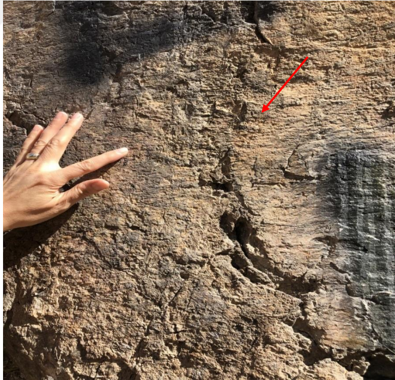
Şekil 3.5. Kaynakların oluşumunu sağlayan doğrultu atımlı fay düzlemi ve üzerindeki kayma çizikleri (Kayma çizikleri ok ile gösterilmiştir. Bakış yönü KD)
