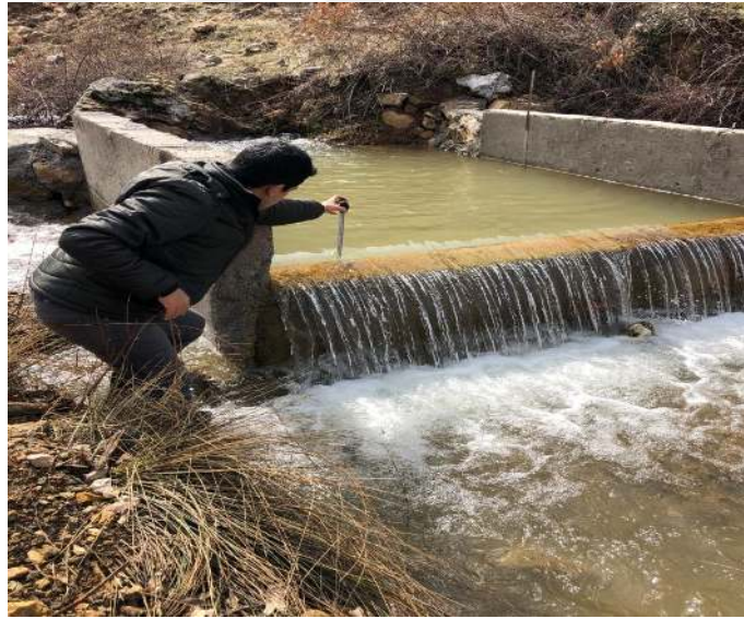
Şekil 2.2. M-5 kaynağı savakta debi ölçümü (Koordinat: 37S439582D, 4231180K)
