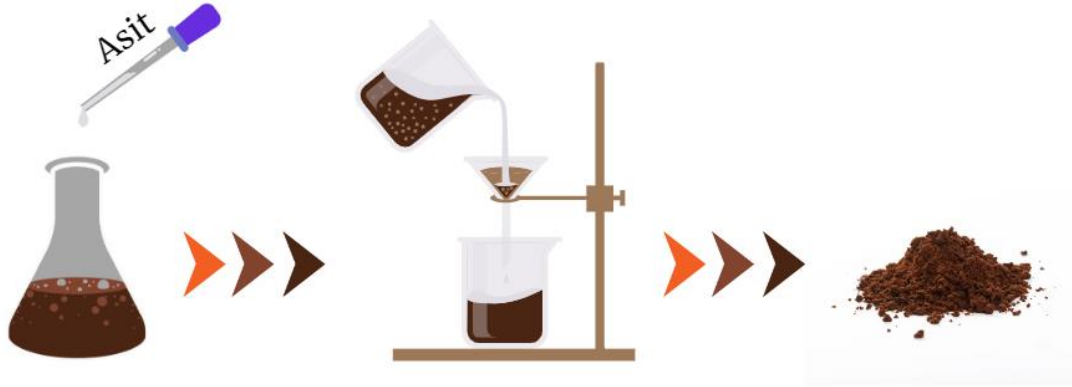
Şekil 3.2: Ligninin asitle çöktürme yöntemiyle siyah çözeltilerden ayrılması
