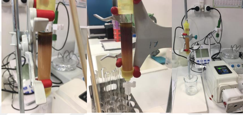
Şekil 3.3: Peristaltik pompa destekli kolon kromatografisi (Fotoğraf: Esra Ceylan, 2019)
