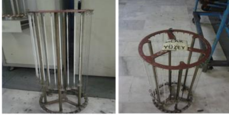
Şekil 3.6. Kaynama çekme testinde kullanılan magazinler
