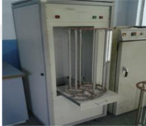
Şekil 3.5. Kaynama çekme ve kıvrım değerlerinin tespitinde kullanılan cihaz
