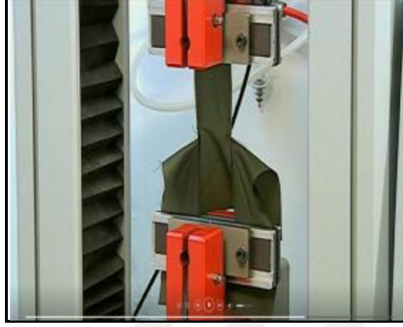
Şekil 3.7. TİTAN çekme cihazında çift yırtmalı dil metodu
