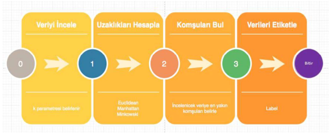
Şekil 4.4. KNN algoritmasının çalışma adımları
