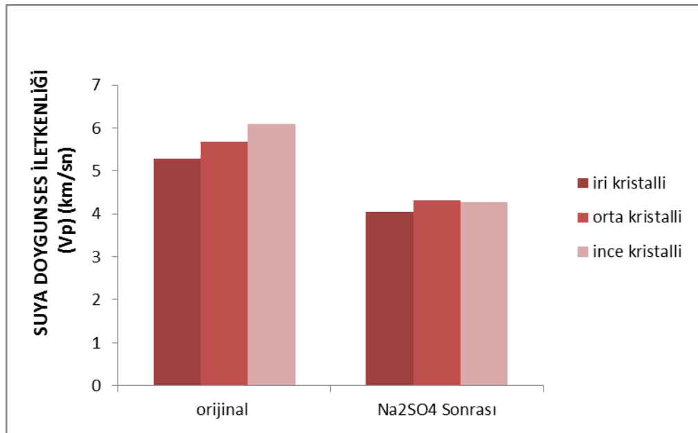
Şekil 7.45 Suya doymun ultrasonik ses hızı iletkenliğinin taze numune ve \text{Na}_2\text{SO}_4 deneyi sonrası değişimi
