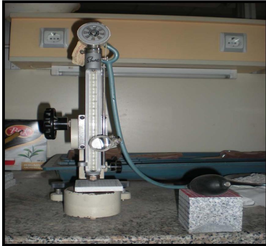
Şekil 6.11 Shore sertlik indeksi deneyi aleti
