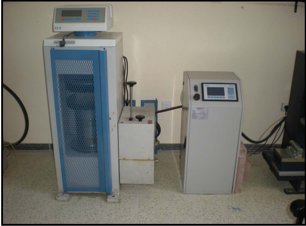
Şekil 6.3 Tek eksenli basınç direnci test aleti
