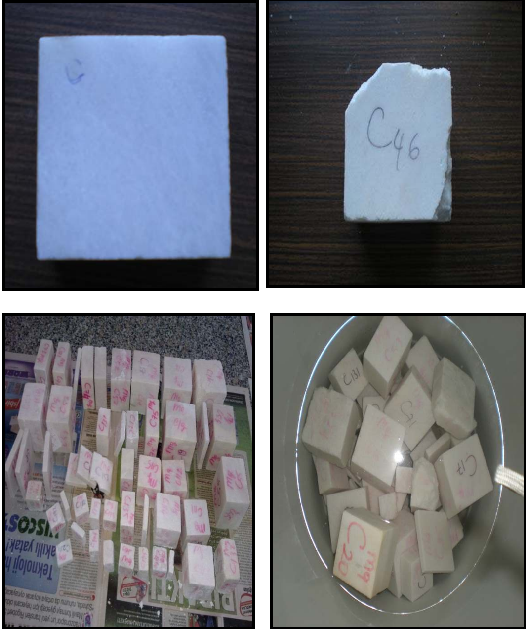
Şekil 7.39 İnce kristalli mermerlerin MgSO_4 deneyi öncesi ve 10., 20. periyot sonrası görünümü
