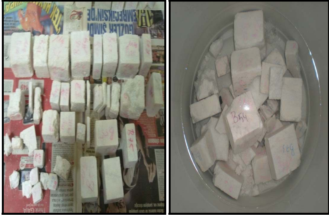
Şekil 7.38 Orta kristal boyutuna sahip mermerlerin MgSO_4 deneyi öncesi ve 10., 20.periyot sonrası görünümü
