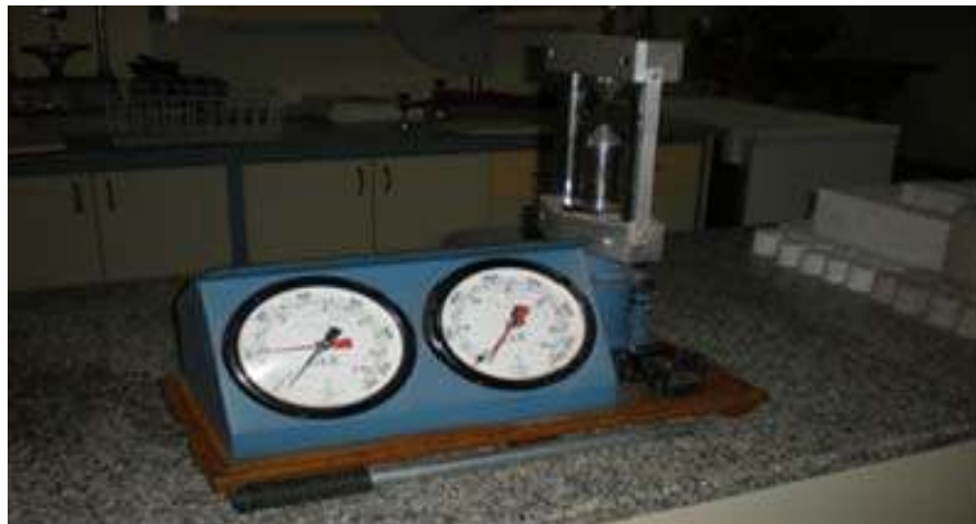
Şekil 6.10 Nokta yükleme dayanım aleti
