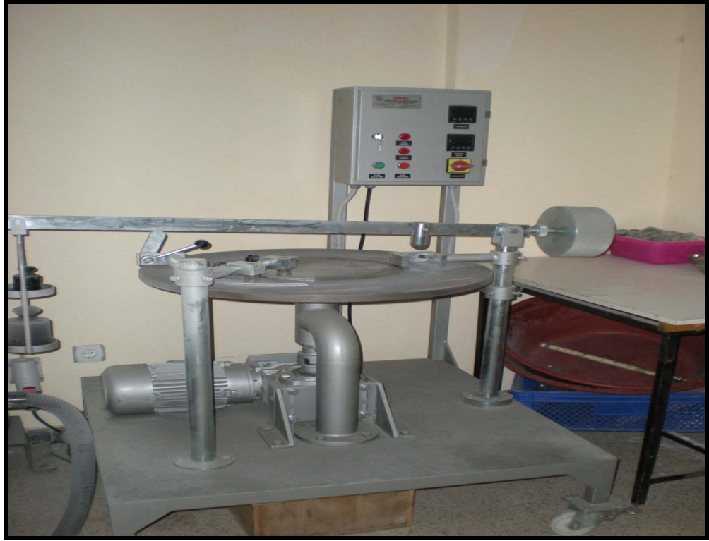
Şekil 6.7 Böhme yüzeysel aşındırma deneyi aleti
