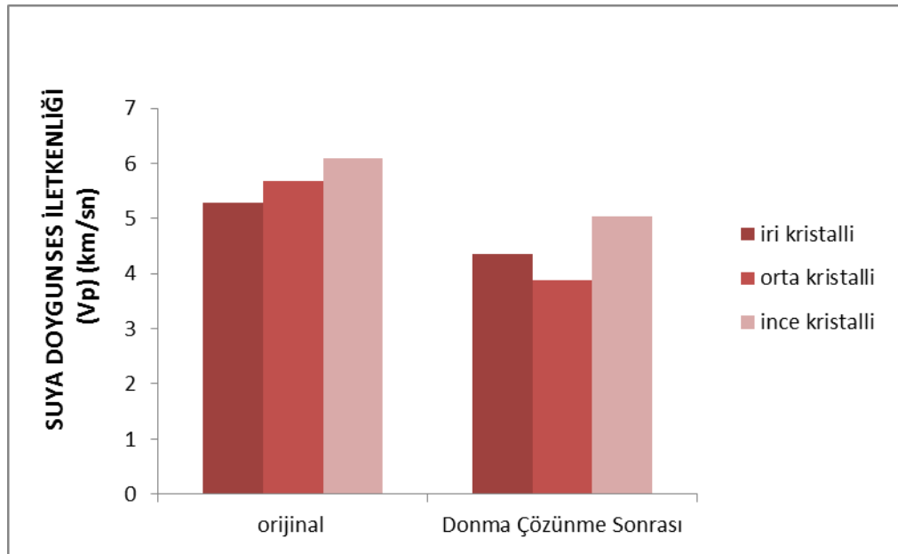
Şekil 7.43 Suyu doymun ultrasonik ses hızı iletkenliğinin taze numune ve donma çözünme deneyi sonrası değişimi
