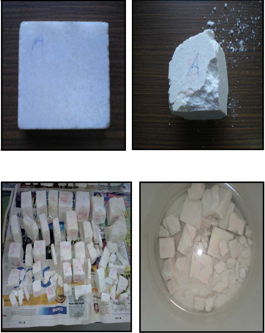
Şekil 7.37 İri kristalli mermer grubunun MgSO_4 deneyi öncesi ve 10. , 20. periyot sonrası görünümü
