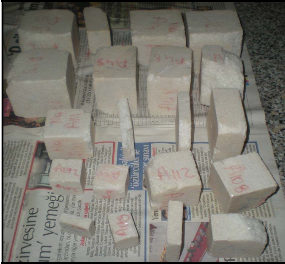
Şekil 7.28 İri kristalli mermer numunelerinin \text{Na}_2\text{SO}_4 tuz kristallenmesi deneyi öncesi ve sonrası görünümü
