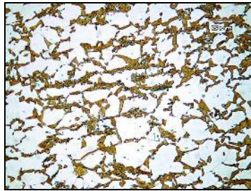
Şekil 2.3 Ferrit (açık renk) martensit (koyu renk) mikroyapısına sahip çift fazlı bir çelik (int.kayn.1).
