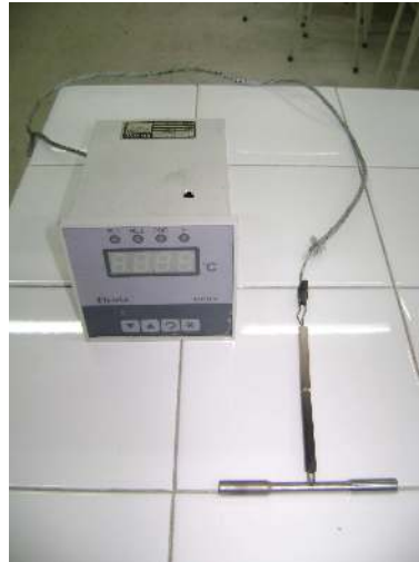
Resim 3.2 Harici sıcaklık ölçer.
