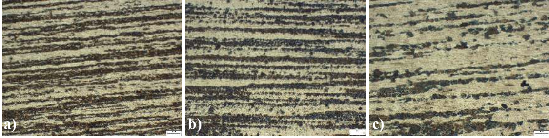
Şekil 4.2 Isıl işlem uygulanmamış çeliklerin kesitten alınmış mikroyapıları X100.
