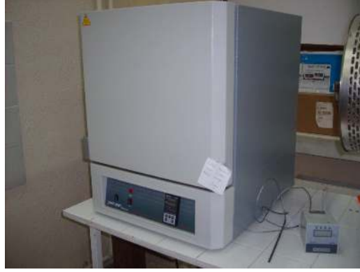
Resim 3.1 Isıl işlem fırını.
