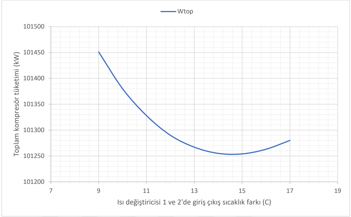
Şekil 43: Isı Değiştiricisi 1 ve 2'de Giriş Çıkış Sıcaklık Farkına Göre Toplam Kompresör Tüketimi Değişimi
