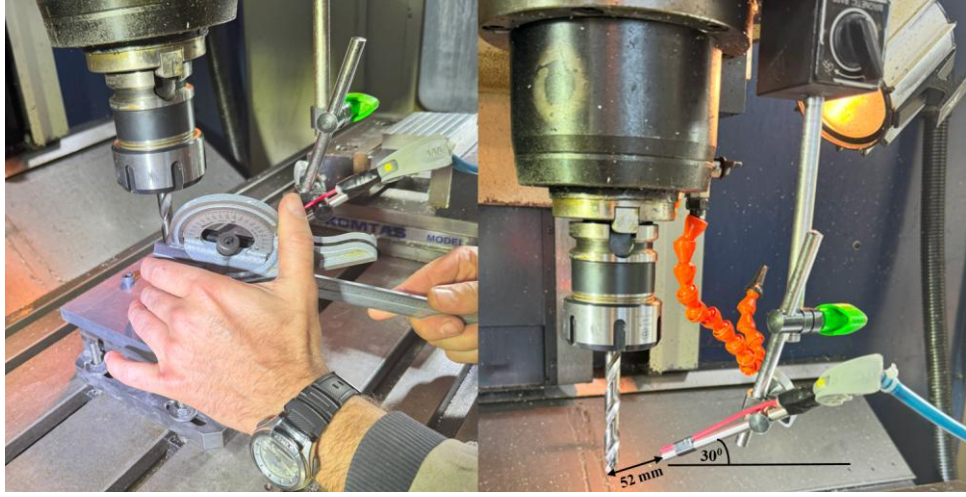
Şekil 4. 8. Soğutucu akışkan nozul mesafe ve açısının ayarlanması
