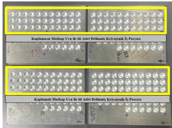
Şekil 4. 23. Kesici takım aşınma testi için yapılan delik delme aşaması
