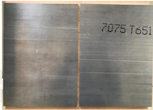
Şekil 4. 1. Deneyde kullanılan alüminyum Al7075 T 651 iş parçası
