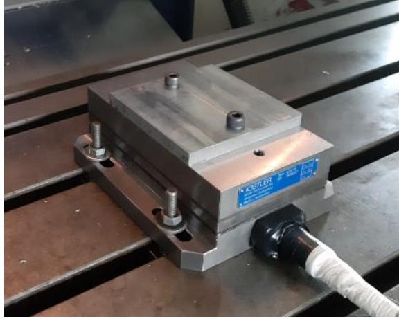
Şekil 4. 15. Dinanometreye bağlanmış iş parçası
