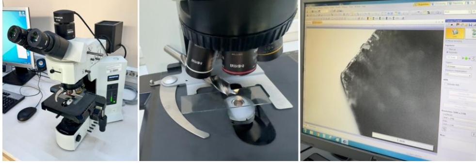
Şekil 4. 24. Kesici takım aşınma mikroskopik aşınma ölçümleri
