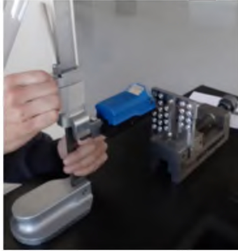
Şekil 4.13. Hommel Tester T500 yüzey pürüzlülük ölçüm cihazı
