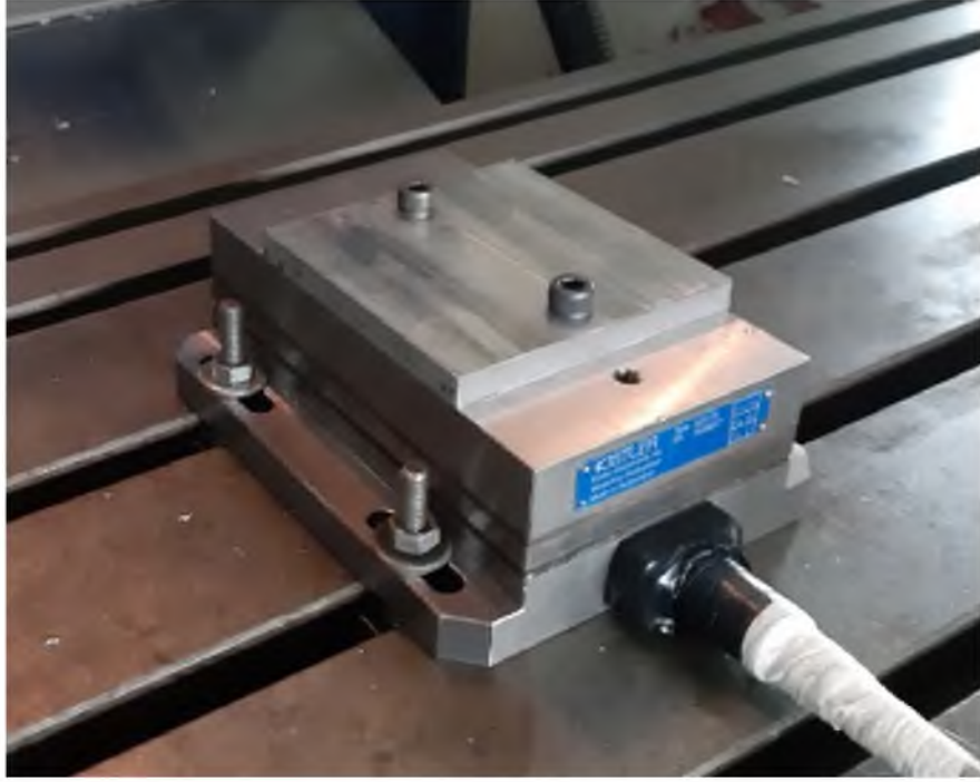
Şekil 4.4. Dinanometreye bağlanmış iş parçası
