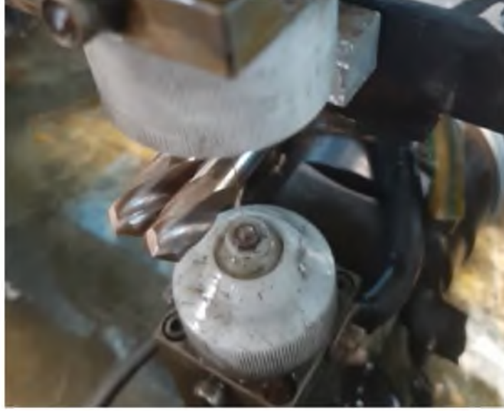
Şekil 4.10. Tel erezyon tezgâhına kesilen takımlar
