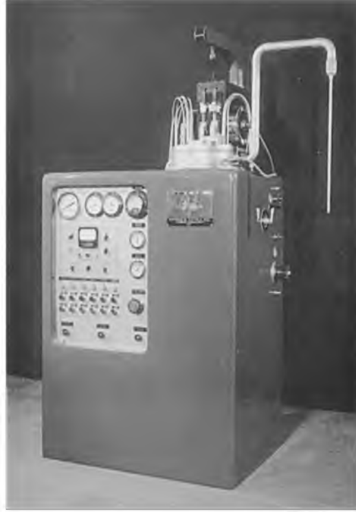
Şekil 3.2. Collins helyum sıvılaştırıcısı (Radebaugh, 2007)
