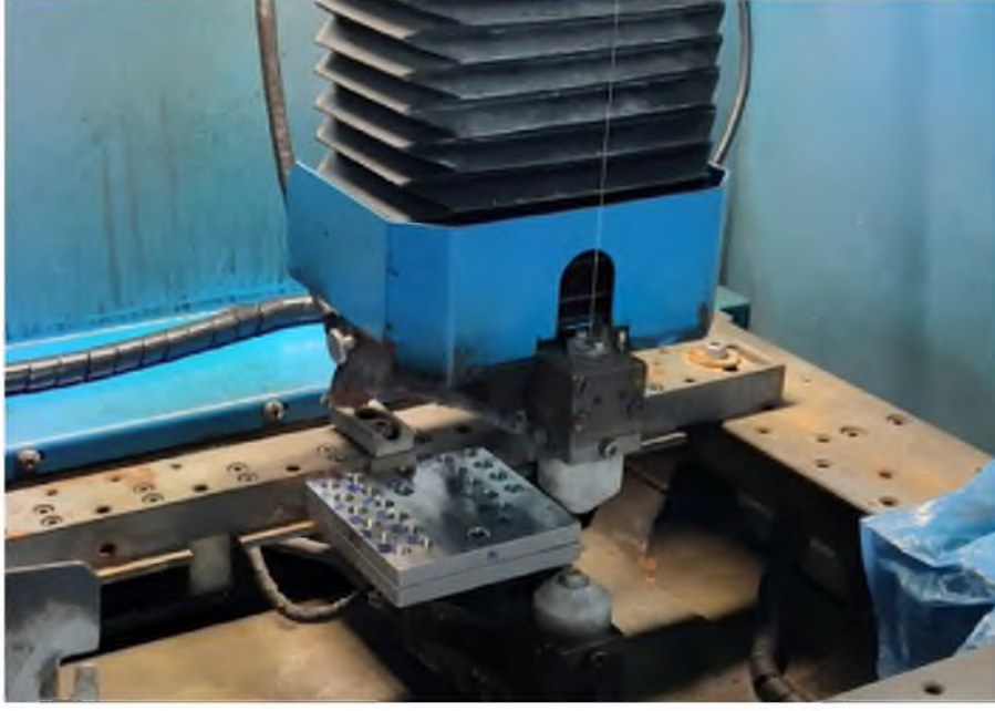
Şekil 4.16. İş parçalarının tel erezyon tezâhında kesilmesi
