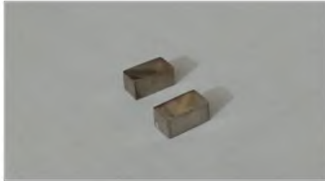
Şekil 4.17. Mikroyapı analizi için hazırlanan numuneler
