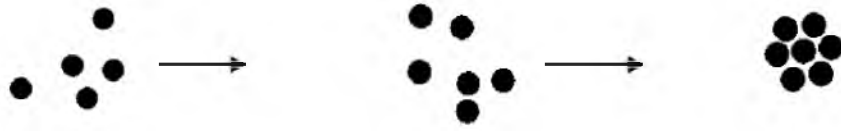
Şekil 3.6. Sıcaklıkta azalma ile atomik seviyelerde bağlanma enerjisinde artış (Kalia, 2010)
