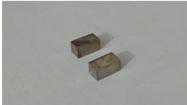
Şekil 4.17. Mikroyapı analizi için hazırlanan numuneler
