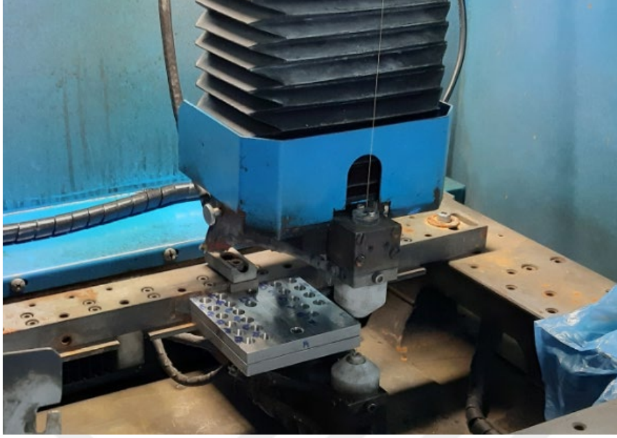
Şekil 4.16. İş parçalarının tel erezyon tezâhında kesilmesi
