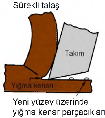
Şekil 3. 11. Yığma Talaş Oluşumu (Oyman, 2012)
