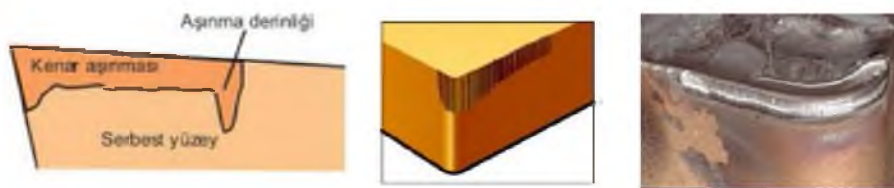
Şekil 3. 22. Serbest Yüzey Aşınması (Anonim).
