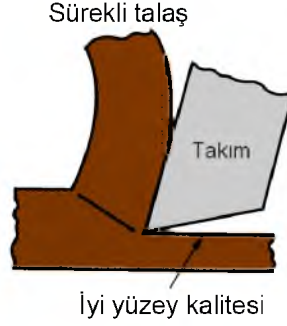
Şekil 3.9. Sürekli Talaş (Akın, 2014).
