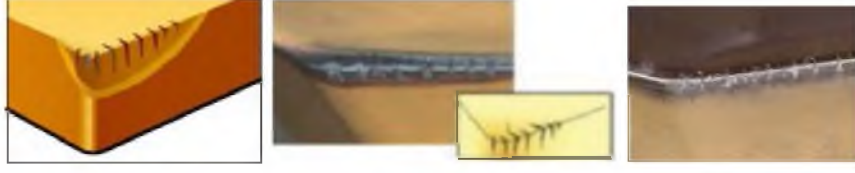
Şekil 3. 28. Termal Çatlak (Anonim)
