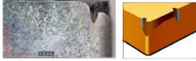
Şekil 3. 24. Çentik Aşınması (Gharbi ve ark., 2019).
