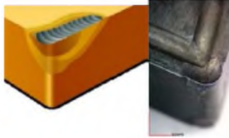
Şekil 3. 23. Krater Aşınması (Gharbi ve ark., 2019).
