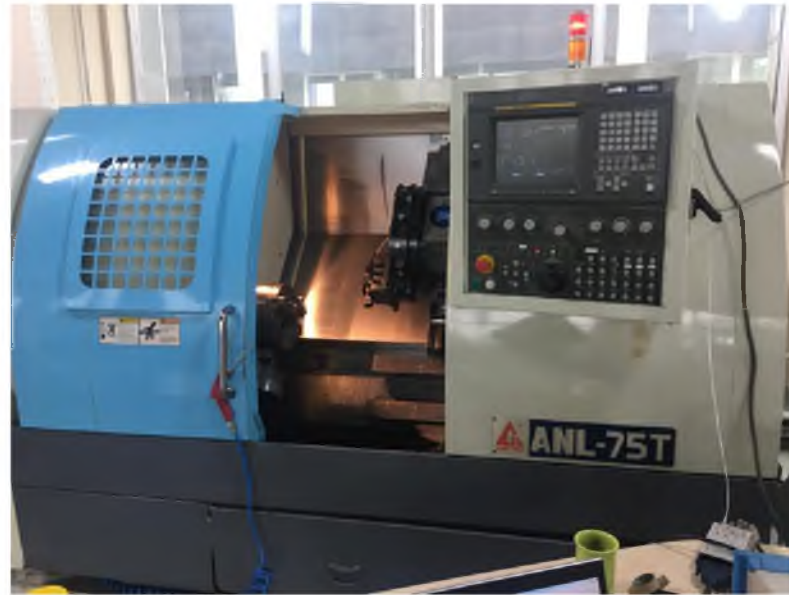
Şekil 4. 2. ALEX TECH ANL-75T, C eksenli CNC Torna tezgâhı
