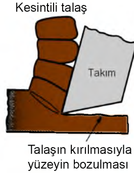
Şekil 3.10. Kesintili Talaş (Akın, 2014).
