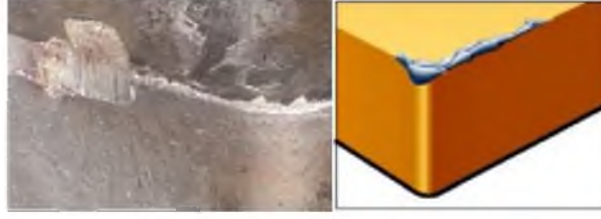
Şekil 3. 27. Talaş Yığılması (BUE) (Anonim) .
