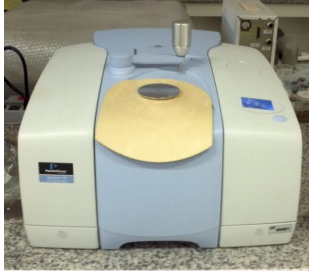
Şekil 32. Perkin-Elmer Spectrum 100 spektrofotometre cihazı.
