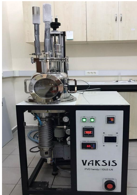
Şekil 23. Soğuk altlık yöntemi için kullanılan cihaz.
