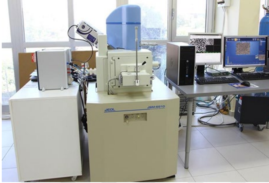
řekil 29. JEOL marka JSM-6510 model taramalı elektron mikroskobu.
