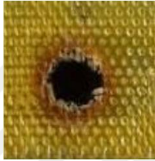
Şekil 1.19. Kompozit malzemelerin delinmesinde matris yanması (Yenigün, 2018)
