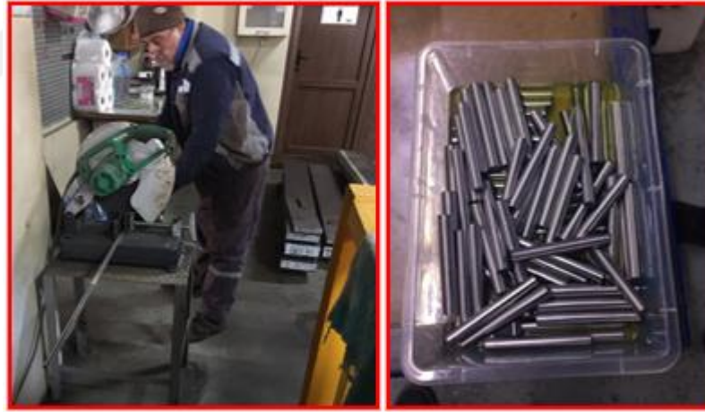
Şekil 3.3. HSS çeliklerin kesilmesi
