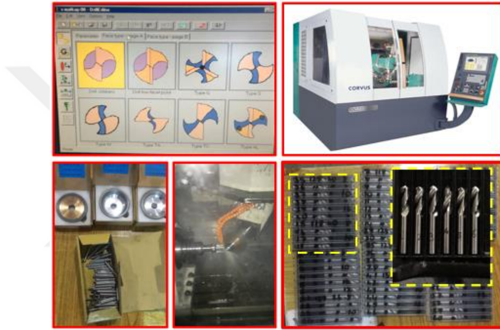
Şekil 3.7. Özel imal edilen matkaplar için kullanılan tezgâh, aparat ve yazılım
