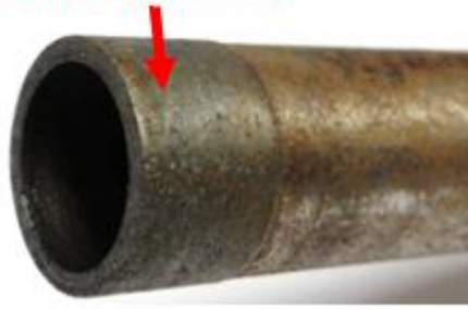
Şekil 1.12. Karot delme işleminde kullanılan takım ucu (Liu ve ark., 2012)
