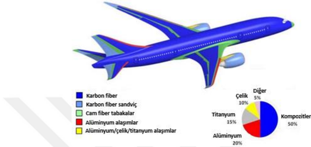
Şekil 1.1. Boeing uçak firmasının 787 modelinde kullandığı malzemeler (Wanhill, 2017)
