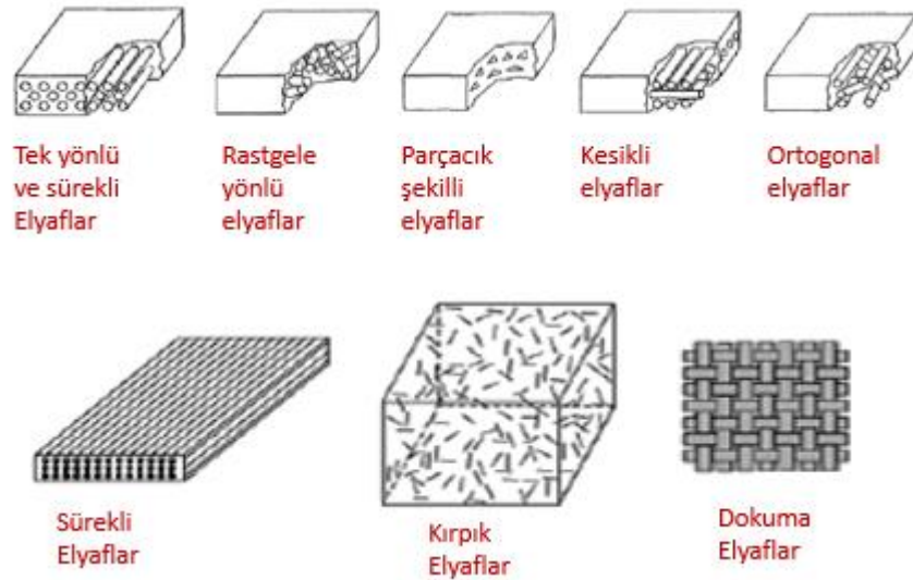
Şekil 1.5. Kompozit malzemelerdeki elyaf takviye şekilleri (Buckley ve Edie, 1993; Sahin, 2006)
