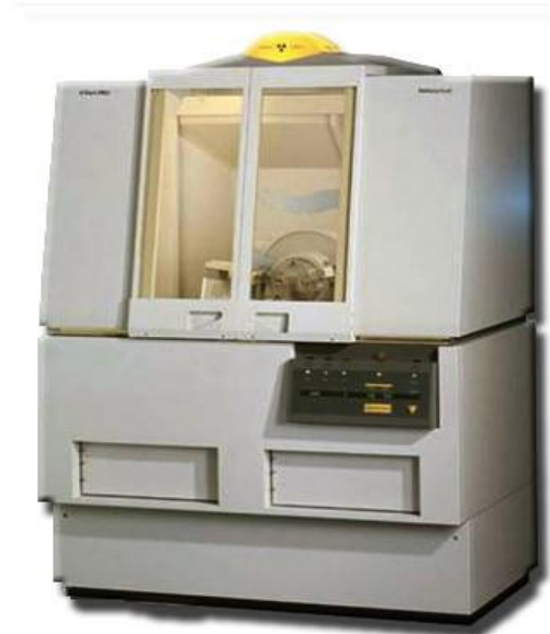
Şekil 7.2. Philips X-pert Pro X ışını kırınım spektroskopi cihazı X-Işını Toz Diffraktometresi: Philips Xpert Pro marka, sentezlenen bileşiklerin faz analizleri için kullanılan cihaz. İzmir Yüksek Teknoloji Enstitüsü Malzeme Araştırma Merkezi (Şekil 7.2.)
