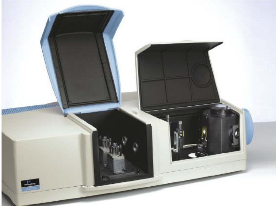
Şekil 6.6. İki farklı tür örnek odasını da içeren Lambda 950 Spektrofotometresi
