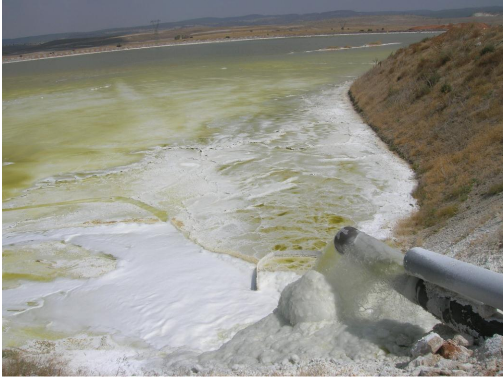
Şekil 2.3 Atık havuzuna boşalım (AII)
