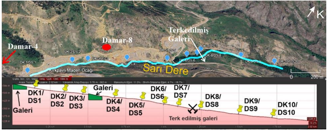
Şekil 30. Dere suyu ve dere kumu örnek alım noktalarının, çalışılan cevherleşmeler ve maden sahasında herhangi bir faaliyet yapılmadan önce eski yıllarda açılmış ve terkedilmiş galerilere göre konumlarını gösteren profil hattı
