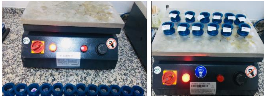
Şekil 3. Parlak kesit numunelerinin sıcak bakalite alınma işlemi
