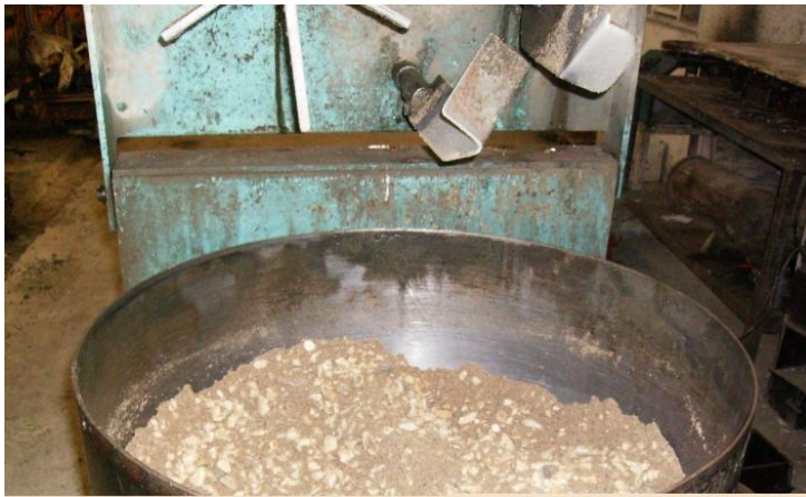
Şekil 1.6. Deneme karışımı yapılan karıştırıcının içine agreganın yerleştirilmesi
