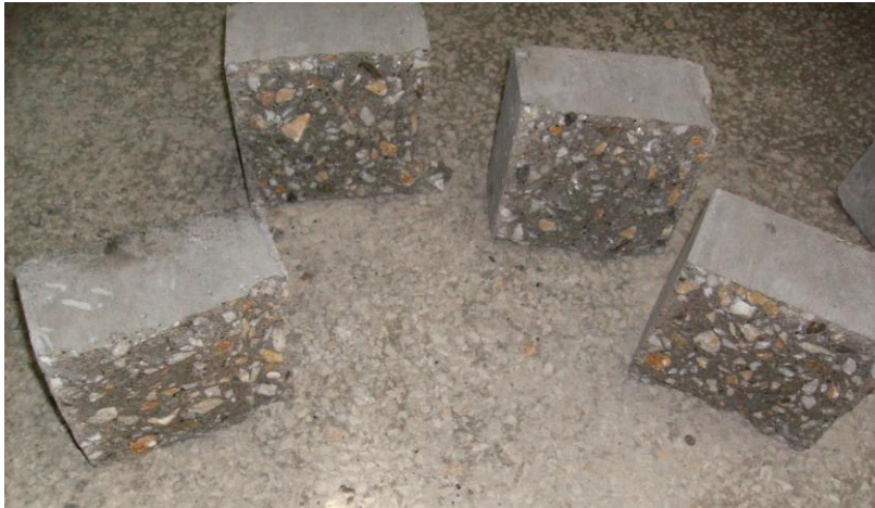
Şekil 3.6. Yarmada çekme deney numunelerinin deneyden sonraki görünüşleri
