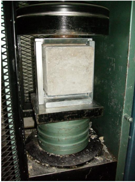
Şekil 1.1. Yarmada çekme deneyinin basınç düzeneğinde gerçekleştirilmesi
